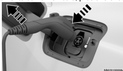
Retirando el conector del puerto de carga del vehículo
