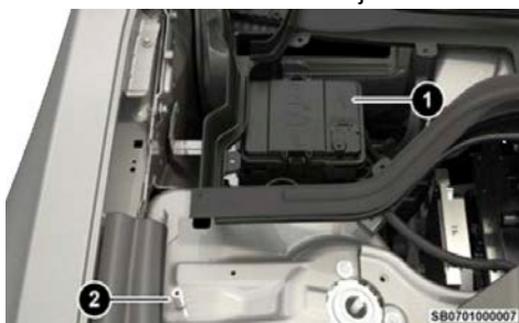
Ubicaciones para el arranque con cables pasacorrente
