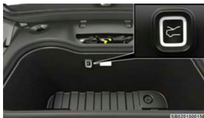
Liberación de emergencia del compartimiento de carga delantero
