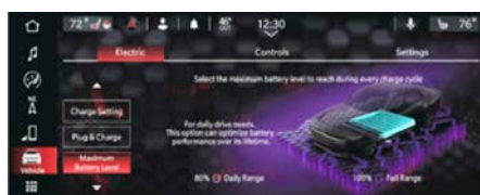
Nivel máximo en la batería
