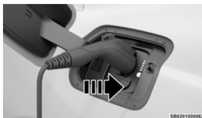
Insertando el conector en el puerto de carga del vehículo
