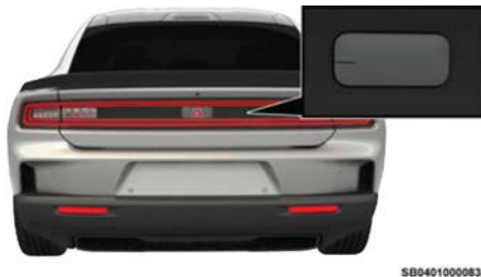
Botón de Entrada Pasiva de la compuerta levadiza
