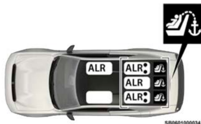
Ubicación retractor de bloqueo automático (ALR).
