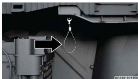
Cables de liberación de emergencia
