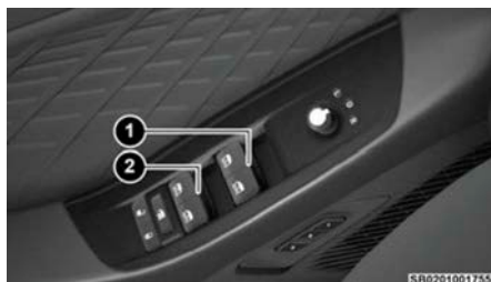
Controles de ventana eléctricas
