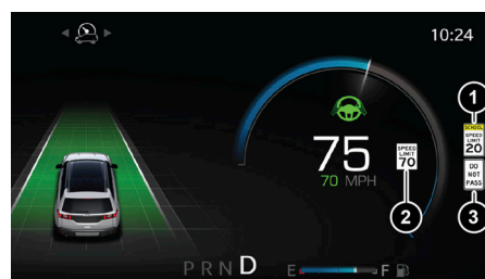
Señales de tráfico reconocidas
