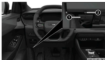
Liberación de emergencia del cofre
