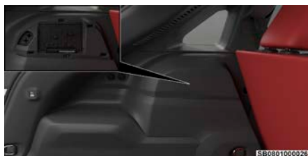
Centro de distribución de energía trasero
