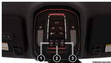
Interruptores del quemacocos
