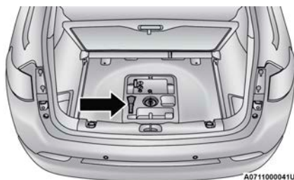
Ubicación del embudo de llenado de emergencia
