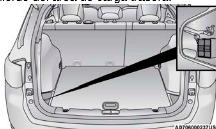
Ubicación de la caja de fusibles trasera
