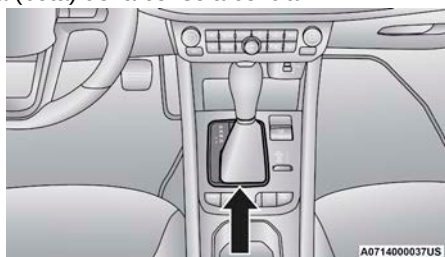
Ensamble del selector de velocidades
