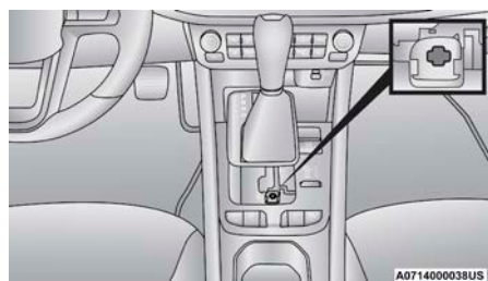
Acceso al orificio anulador del selector de velocidades
