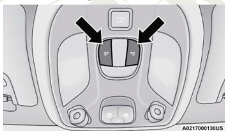
Interruptores de luces de consola superior
