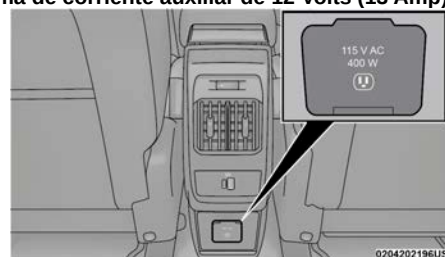
Inversor de corriente
