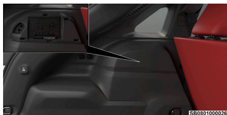
Centro de distribución de energía trasero
