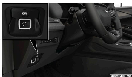
Interruptor del freno de estacionamiento (EPB)
