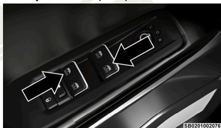
Interruptores de las ventanas eléctricas de la puerta del conductor
