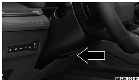
Columna de la dirección eléctrica abatible/telescópica
