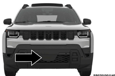
Sensor de radar delantero
