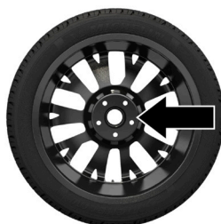
Superficie de montaje de la rueda
