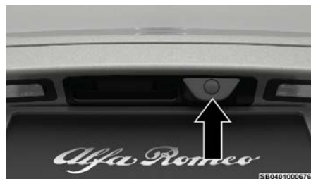
Ubicación de la cámara de reversa
