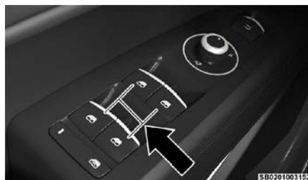
Interruptores de las ventanas
