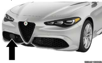
Ubicación del radar en la defensa delantera
