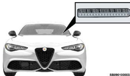
Localización de VIN en el parabrisas
