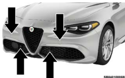
Ubicación de los sensores delanteros
