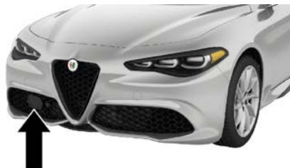
Ubicación del radar en la defensa delantera
