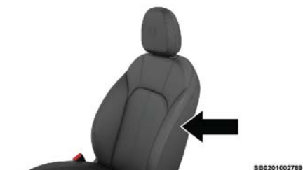
Bolsa de aire lateral complementaria instaladas en el asiento
