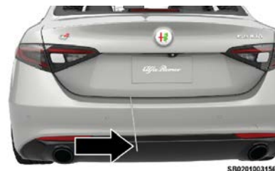
Cordón de liberación manual con la compuerta trasera cerrada
