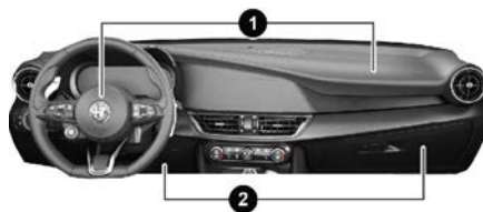
Ubicación de la bolsa de aire frontal/protectores de impacto de rodilla
