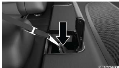
Ubicación de los anclajes para correa superior
