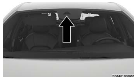
Ubicación de la cámara del parabrisas
