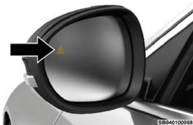
Ubicación de luz indicadora del BSM
