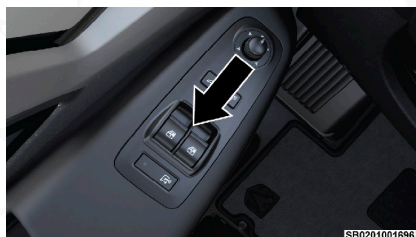
Interruptores de las ventanas eléctricas
