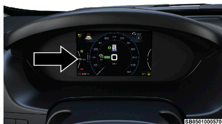
Pantalla de batería de alto voltaje
