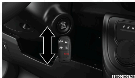
Encendido con batería de transmisor descargada
