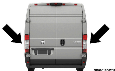
Ubicación de los sensores de radar
