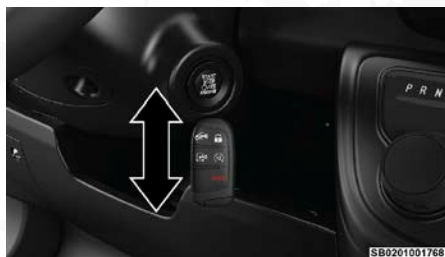
Encendido con batería de transmisor descargada
