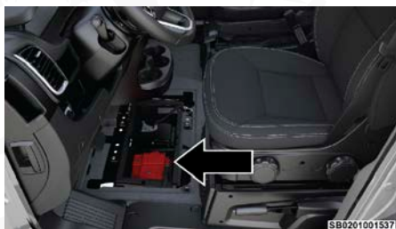
Ubicación de la batería
