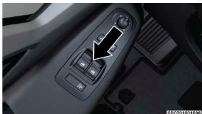
Interruptores de las ventanas eléctricas
