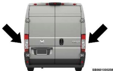
Ubicación de los sensores de radar
