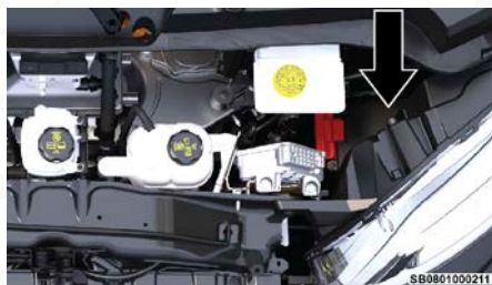
Centro de distribución de energía frontal
