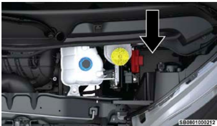
Centro de distribución de energía frontal
