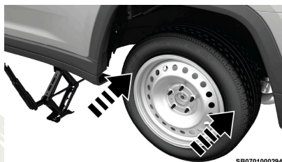
Montado de la llanta de refacción
