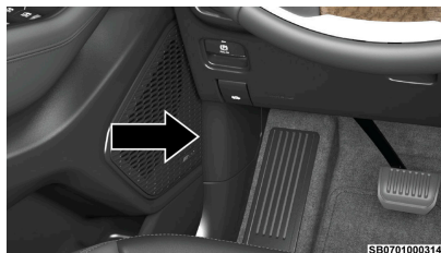
Cubierta de acceso al liberador de la posición de estacionamiento
