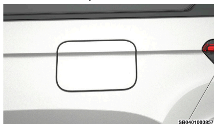
Puerta de relleno de combustible
