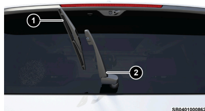
Limpiaparabrisas removido del brazo limpiador
