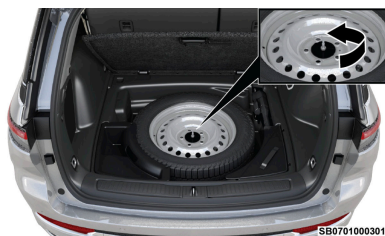
Retiro del sujetador de la llanta de refacción
