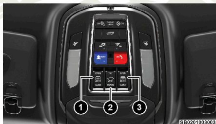
Interruptores de toldo solar y cortinilla
