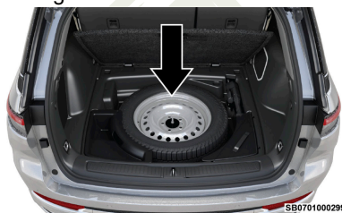
Llanta de tamaño normal instalada en la ubicación de la llanta de refacción
