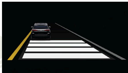
Abandono de carril detectados (líneas en amarillo sólido)
