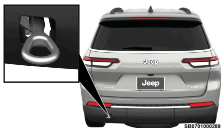
Argolla de arrastre trasera instalada
