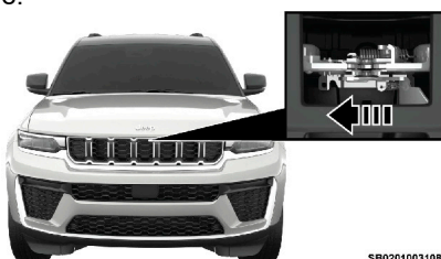
Localización del broche de seguridad
