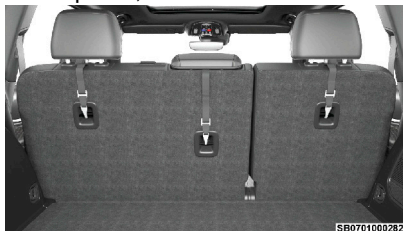
Montaje de la correa superior en la segunda fila de asientos tipo banca (vehículos de 5 y 7 pasajeros)
