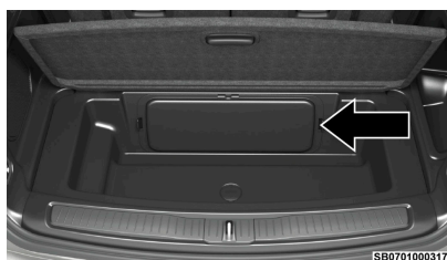
Ubicación del almacenaje del gato (detrás de la tercera fila de asientos, en vehículos sin suspensión de aire)
