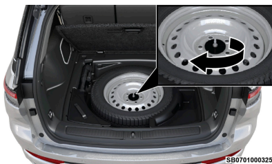
Reinstalación del sujetador de la llanta
