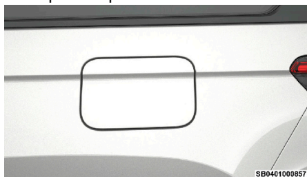
Compuerta de llenado de combustible
