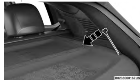
Desconexión de los postes de la cubierta
