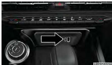
Ubicación de la toma de corriente
