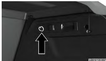
Ubicación del liberador de la compuerta.
