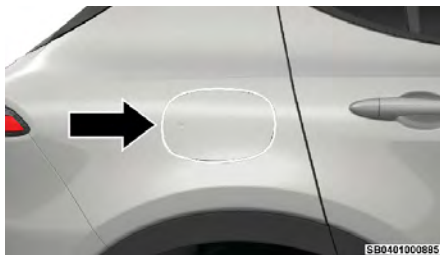
Compuerta de combustible
