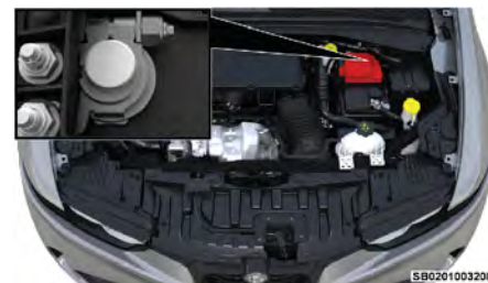
Poste positivo (+) de la batería
