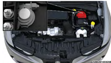
Poste positivo (+) de la batería
