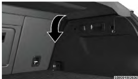
Retiro del poste de la cubierta
