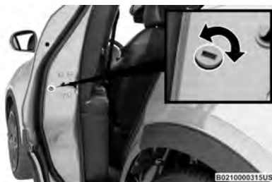
Bloqueo de emergencia
