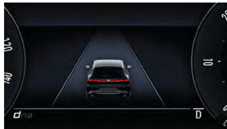
Sistema encendido (líneas grises)
