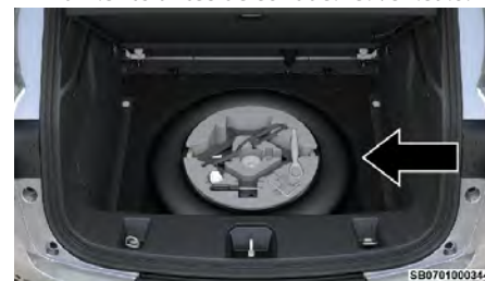
Almacenamiento de la llanta dañada
