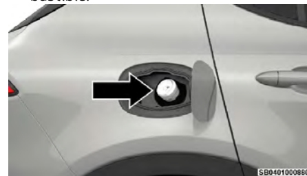
Tubo de llenado de combustible
