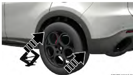
Montando la llanta de refacción
