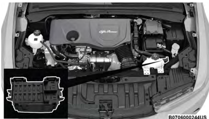
Ubicación de la caja de fusibles suplementaria
