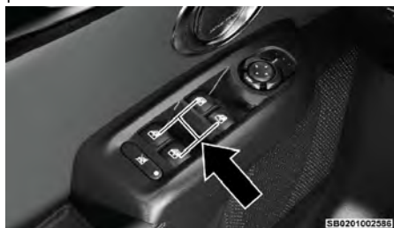
Interruptores de las ventanas
