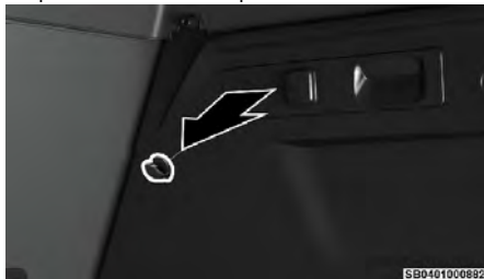
Liberación de emergencia de la compuerta
