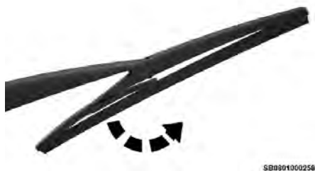
Retiro de la hoja del limpiaparabrisas
