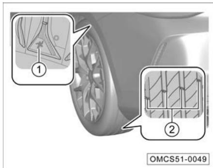
La marca ① es utilizada para indicar la condición de desgaste del dibujo exterior. Si el círculo exterior del neumático se desgasta a lo mostrado, el neumático ya no se puede usar de manera segura y debe reemplazarse de inmediato.
