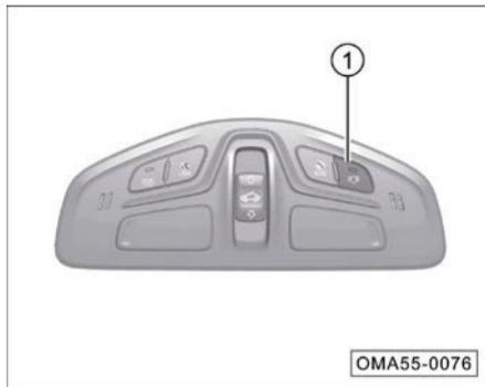
Cuando presione el interruptor ①, la luz indicadora en el interruptor se encenderá y la función de encendido automático de las luces de techo se activará. Cuando presiona el interruptor nuevamente, la luz indicadora del interruptor se desactivará.
