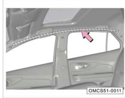
Las bolsas de aire laterales de cortina se encuentran dentro de los costados izquierdo y derecho del cielo o interior del techo (área sombreada con línea punteada), indicada con la leyenda "AIRBAG".
