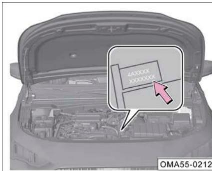
El número de serie del motor se encuentra indicado en la flecha en el bloque del motor (encima del alternador).
