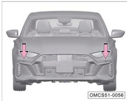
Los sensores de radar ultrasónicos delanteros están instalados en la cubierta de la defensa delantera.
