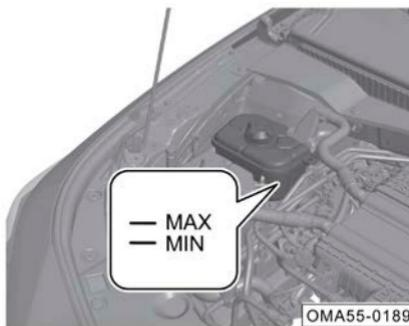
Revise que el nivel de refrigerante en el tanque de expansión de refrigerante del intercooler está entre la marca superior "MAX" y la marca inferior "MIN".
