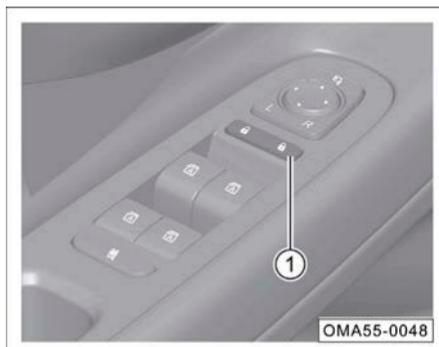
El botón de bloqueo centralizado de puertas ① puede utilizarse para bloquear y desbloquear las puertas del vehículo:
