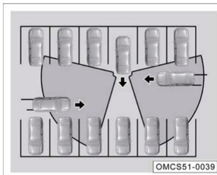
El sistema de alerta de tráfico cruzado trasero (RCTA) detecta en los puntos ciegos a ambos lados de la parte trasera del vehículo a través sensor BSD. Cuando el vehículo está en reversa, y se detecta un vehículo acercándose, el sistema le advertirá al conductor a través de alertas visuales en los retrovisores exteriores, módulo de instrumentos o imagen panorámica (si así está equipado).
