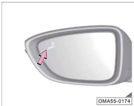
El sistema de advertencia de apertura de puerta alerta al conductor a través de la luz indicadora
