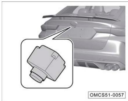
La cámara de visión trasera está montada cerca de la luz de la matrícula.
