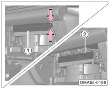
6. Presione el retenedor de la cubierta del filtro en la dirección señalada por las flechas y retire la cubierta el filtro de aire ①.
