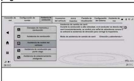
Con el interruptor de ignición del vehículo en la posición de "Encendido" (ON) o al arrancar el vehículo, seleccione en el sistema de infotainment: "Configuración del sistema → Asistencia de conducción → Asistencia de control lateral del vehículo", y presione el interruptor en pantalla a la derecha del ajuste para activar o desactivar el sistema.
