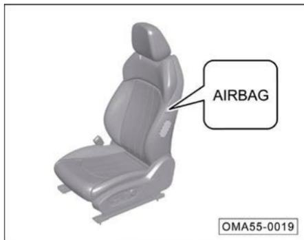
Las bolsas de aire laterales delanteras se encuentran instaladas al interior del respaldo del asiento en el costado externo del conductor y pasajero (área sombreada con línea punteada), indicadas con la leyenda “AIRBAG”.
