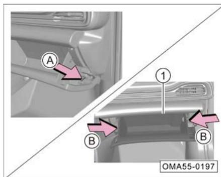
3. Desconecte el retenedor de la guantera tirando en la dirección de la flecha A.
