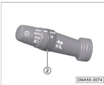
Con el interruptor de ignición en la posición “Encendido (ON) y las luces de posición encendidas, o faros en luz baja encendidos, gire el interruptor de la luz antiniebla trasera ② para encender o apagar la luz antiniebla trasera ④.
