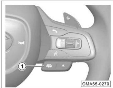
Para el encendido o apagado del sonido del escape de acuerdo a los distintos modos de conducción presionando el interruptor ① en el costado derecho del volante.
