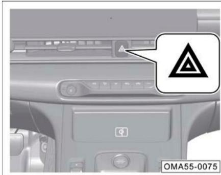
Si presiona el interruptor ④ con el interruptor de ignición en cualquier posición, la luz indicadora en este interruptor destellará y las luces de advertencia (intermitentes) se encenderán. Presione este interruptor nuevamente para apagar las luces.
