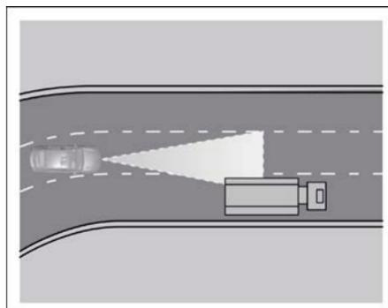
3. Conduciendo fuera de una curva. Cuando conduce fuera de una curva prolongada, el ACC calculará el carril en avanzada, el radar podría reaccionar a vehículos en los carriles adyacentes al que circula y aplicará el freno de estacionamiento. El proceso de frenado puede interrumpirse presionando el pedal de freno.
