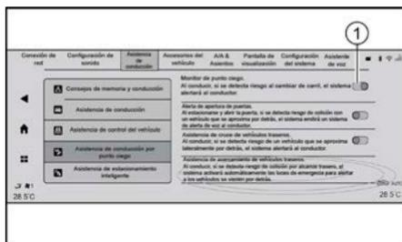
Cuando el interruptor de la ignición está en "Encendido" (ON) o se enciende el motor, se puede activar o desactivar el BSD en el sistema de infotainment "Configuración del sistema → Asistencia de conducción → Asistencia BSD", presionando el interruptor en el costado derecho para encenderlo o apagarlo.
