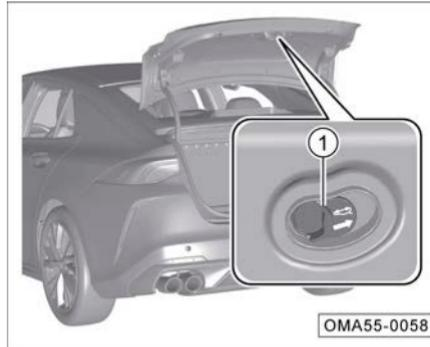
Cuando el vehículo no cuente con batería o la cajuela falle en abrir de forma normal, usted puede intentar la liberación de emergencia al interior del vehículo:
