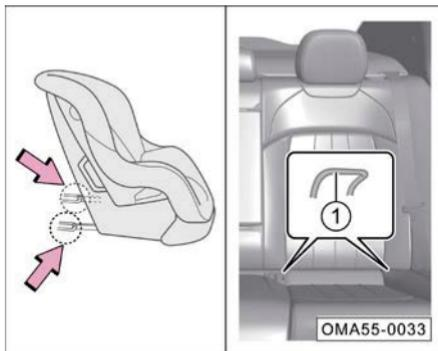
1. Coloque el sistema de protección para niños en el asiento del vehículo, encuentre los puntos de anclaje inferiores ① e inserte el riel de instalación (señalado con las flechas) al punto de fijación inferior ①, hasta que escuche el sonido de "clic".
