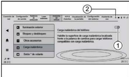
Cuando el interruptor de ignición está en la posición "Encendido" (ON), en el sistema de infotainment, ingrese a "Configuración del vehículo → Accesorios → Superficie de carga inalámbrica":
