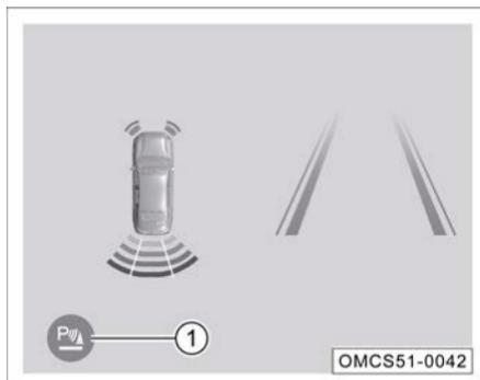
Cuando el sistema RPA está encendido durante la reversa, presione el interruptor 1
