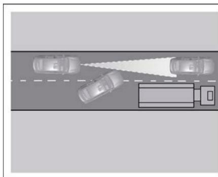
5. Cuando otro vehículo cambia de carril. Cuando el vehículo en el carril adyacente a usted cambia a su carril, si el vehículo no ingresa al rango de detección al frente de su vehículo, el radar podría no detectarlo, resultando en una respuesta retrasada del sistema del ACC.
