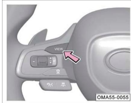
Con el interruptor de ignición en la posición "ON" (Encendido), presione el botón "VIEW" (Vista) del lado izquierdo del volante para acceder al ajuste de tema de la pantalla del módulo de instrumentos.
