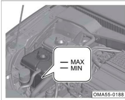
Revise que el nivel de refrigerante en el tanque de expansión de refrigerante del motor está entre la marca superior "MAX" y la marca inferior "MIN".
