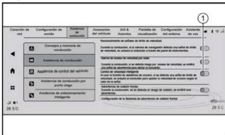
En la interfaz del sistema de infotainment, acceda a “Configuración del sistema → Asistencia de conducción → Control del vehículo”, y presione el interruptor en pantalla al costado derecho del ISLACC, para activarlo o desactivarlo.
