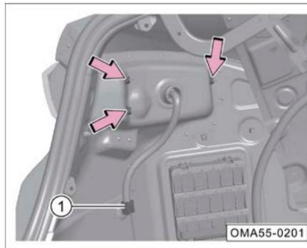
4. Desconecte el conector ① de la luz de combinación trasera A.
