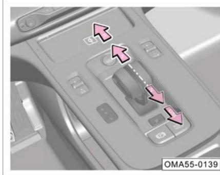
El selector de velocidades cuenta con las posiciones: "P (Estacionamiento) → R (Reversa) → N (Neutral) → D (Conducción) → M (Cambio manual, si así está equipado)". Cuando el interruptor de la ignición está en la posición de Encendido (ON), se mostrará la posición del selector de cambios en la pantalla del módulo de instrumentos.
