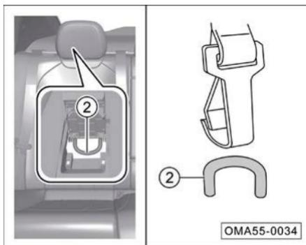
2. Pase la correa a través del pilar de la cabecera, abra la cubierta protectora del punto de anclaje superior ②, y fije el gancho de la correa al punto de anclaje superior ② sin torcer la correa.
