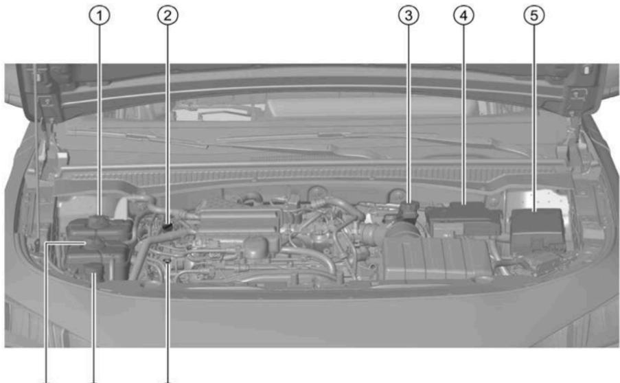
1. Depósito del refrigerante del intercooler.
