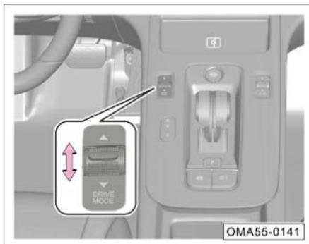
Coloque la ignición en la posición de “Encendido” (ON). Moviendo el interruptor de modos de ignición, puede ciclará entre los modos de la siguiente forma ECO → COMFORT → SPORT → SPORT+ → DIY → ECO.
