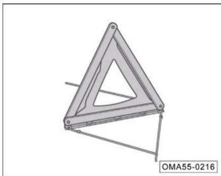
Abra la cajuela, levante el piso de carga y saque el triángulo de advertencia y extiéndala para su uso.
