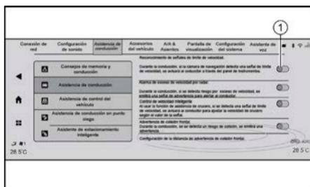
En la interfaz del sistema de infotainment, acceda a “Configuración del sistema → Asistencia de conducción → Control del vehículo”, y presione el interruptor en pantalla al costado derecho del TSR, para activarlo o desactivarlo.
