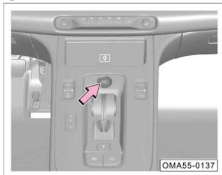
Sólo se puede activar el interruptor de ignición (interruptor START STOP) cuando el transmisor de llave inteligente a control remoto está en el vehículo y es detectado.
