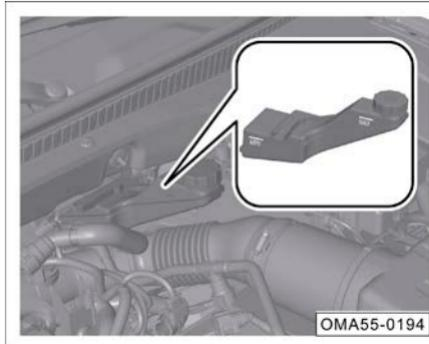
Con el motor frío, verifique que el nivel del líquido de freno esté la marca superior "MAX" y la marca inferior "MIN".
