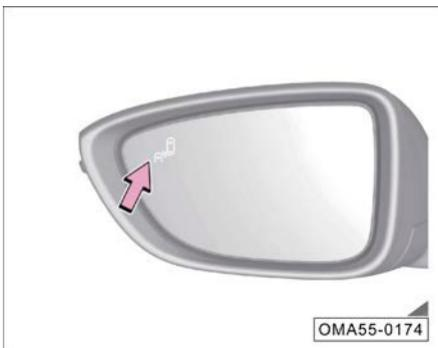
El BSD alerta al conductor a través de la luz indicadora
