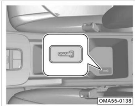
Si la batería del transmisor de llave inteligente se encuentra baja, y la pantalla del módulo de instrumentos muestra el mensaje “Llave no detectada”, puede colocar el transmisor horizontalmente dentro de la marca correspondiente al fondo del compartimiento del descansabrazos y presionar el interruptor de ignición para cambiar a las posiciones de “Accesorios” (ACC) o “Encendido” (ON), o presionar el pedal de freno, y el interruptor de ignición para encender el motor.
