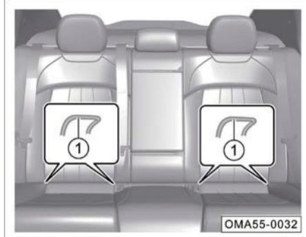
**NOTA:** Los puntos de fijación inferiores ① de los dos asientos traseros está escondido entre la separación del respaldo y el asiento.
