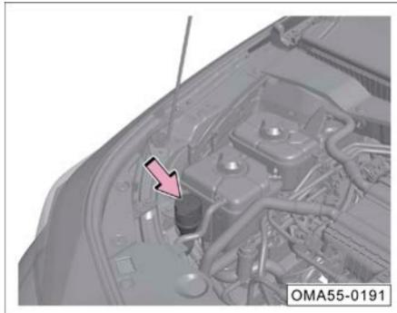
Si el nivel de líquido de lavado en el depósito es demasiado bajo, debe agregar a la brevedad.
