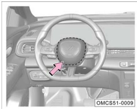
La bolsa de aire frontal del conductor se encuentra dentro del volante (como lo indica la línea punteada), indicada con la leyenda "SRS AIRBAG".
