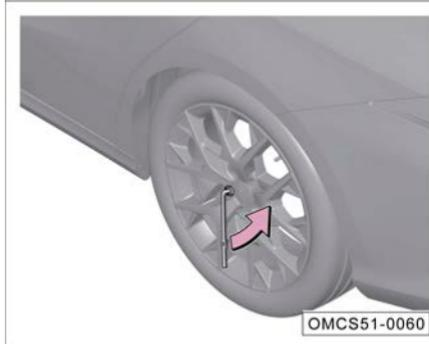
Fije la llave de desmontaje tornillos/tuerzas firmemente y aflojelas girando en el sentido contrario al de las manecillas del reloj.
