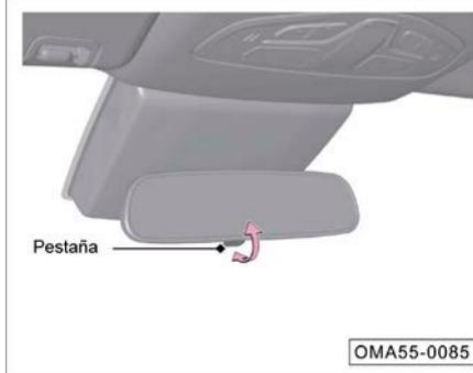
Para los vehículos con espejo retrovisor interior antideslumbrante manual, puede ajustar manualmente el espejo retrovisor interior para reducir la luz reflejada y hacer que la visión trasera esté en la condición de observación óptima.
