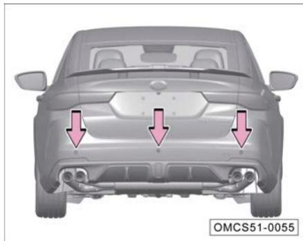
Los sensores de radar ultrasónicos traseros están instalados en la cubierta de la defensa trasera.
