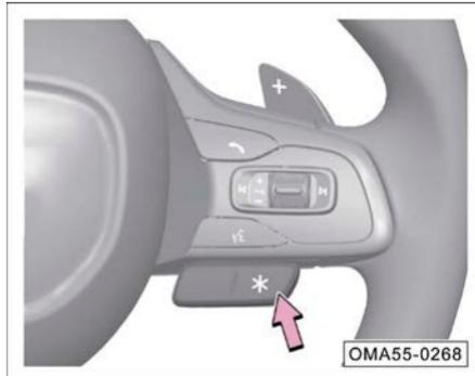
En el costado derecho del volante, existe el interruptor \*. Este interruptor tiene dos estados funcionales, presión corta, y presionar y mantener presionado (presión prolongada). El usuario puede establecer las funciones para el estado de presión prolongada, y presión corta, en la central de control y AVN respectivamente.
