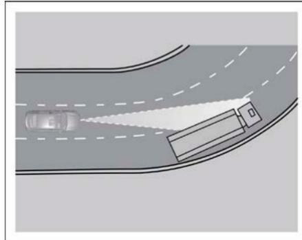
2. Conducción a través de una curva. Cuando conduce a través de una curva, el sensor de radar podría no detectar el vehículo delante de usted o no podría reaccionar a vehículos en los carriles adyacentes al que circula. En este caso, el ACC podría aplicar el freno ante un vehículo frente a usted, reducir la velocidad o no contar con respuesta ante un vehículo al frente suyo. Presione el pedal de freno o cancele el ACC para salir del sistema.
