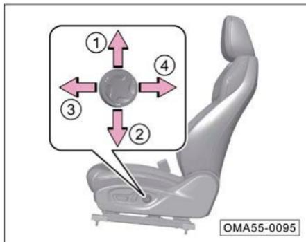
Presione el interruptor en la dirección de la flecha ①, flecha ②, flecha ③ y flecha ④ para desplazar el soporte hacia arriba, hacia abajo, o hacia delante y hacia atrás.
