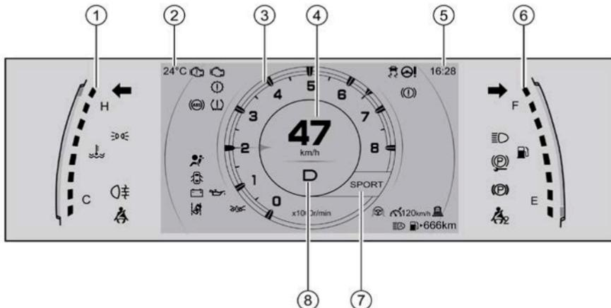
1. Indicador de la temperatura del refrigerante del motor
