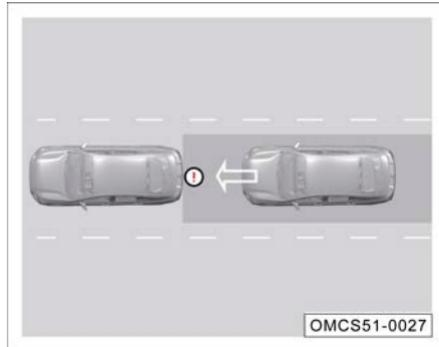
La función de alerta de aproximación trasera monitorea el vehículo “objeto” detrás de usted en tiempo real a través del sensor BSD en la parte trasera de su vehículo. Cuando el conductor conduce de forma normal y el vehículo detrás de usted se acerca rápidamente, el sistema emitirá un mensaje de advertencia y una señal de advertencia de colisión posterior para señalizar el vehículo detrás de usted.
