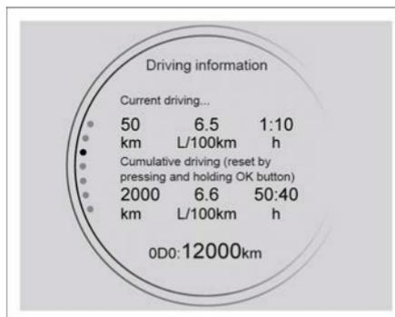
Cuando el interruptor de ignición está en la posición "ON" (Encendido), mueva el botón "OK" del volante hacia arriba o hacia abajo en la parte izquierda del volante para cambiar la información visualizada en pantalla
