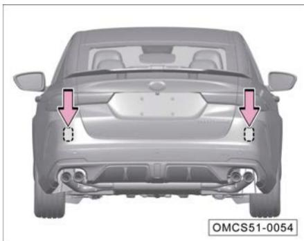
Los sensores de radar del sistema de monitoreo de punto ciego se encuentran ubicados como se muestra en la figura.
