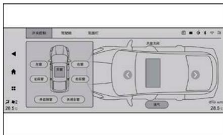
La apertura o cierre del toldo solar puede controlarse con los interruptores digitales en pantalla, como "Ventilación" y "Abrir" en la sección "Mi vehículo" o en el modelo 3D en pantalla.
