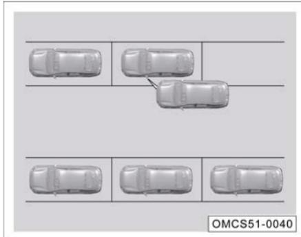
El sistema de advertencia de apertura de puerta (DOW) utiliza el sensor del BSD instalado en la parte trasera para detectar el vehículo en el carril adyacente durante el estacionamiento, cuando el vehículo se detecta aproximándose rápidamente y puede existir un riesgo de colisión si la puerta se abre, el conductor será alertado a través de una alerta visual en el espejo retrovisor exterior correspondiente y una alerta sonora.
