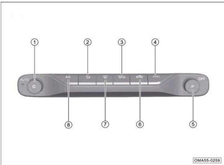
1. Interruptor de aire acondicionado (A/C) automático / Perilla de control de temperatura
