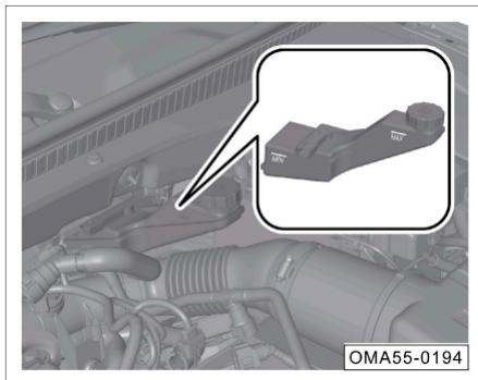
Con el motor frío, verifique que el nivel del líquido de freno esté la marca superior “MAX” y la marca inferior “MIN”.
