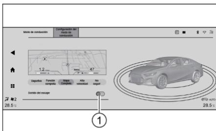
Ingrese a la configuración del modo de conducción actual, y seleccione el interruptor ① para encender o apagar el sonido de escape de acuerdo a los diferentes modos de conducción.
