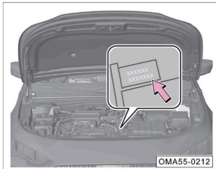
El número de serie del motor se encuentra indicado en la flecha en el bloque del motor (encima del alternador).
