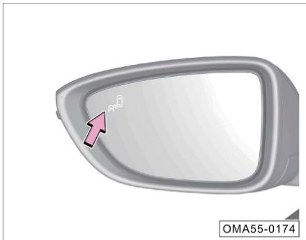
El sistema de advertencia de apertura de puerta alerta al conductor a través de la luz indicadora
