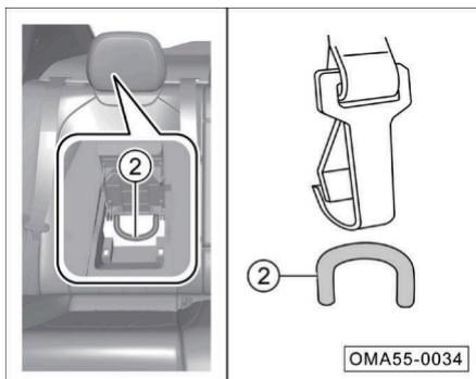
2. Pase la correa a través del pilar de la cabecera, abra la cubierta protectora del punto de anclaje superior ②, y fije el gancho de la correa al punto de anclaje superior ② sin torcer la correa.
