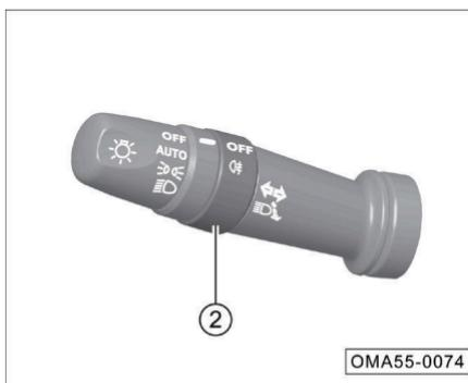
Con el interruptor de ignición en la posición “Encendido (ON) y las luces de posición encendidas, o faros en luz baja encendidos, gire el interruptor de la luz antiniebla trasera ② para encender o apagar la luz antiniebla trasera ③.
