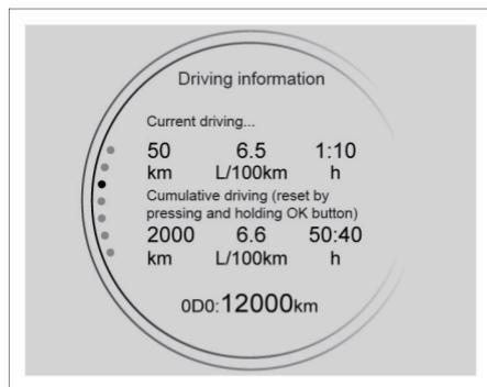
Cuando el interruptor de ignición está en la posición "ON" (Encendido), mueva el botón "OK" del volante hacia arriba o hacia abajo en la parte izquierda del volante para cambiar la información visualizada en pantalla
