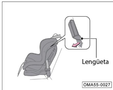
3. Mueva hacia abajo la lengüeta y pase la porción superior del cinturón de seguridad a través de la hendidura lateral del sistema de protección infantil.
