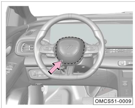
La bolsa de aire frontal del conductor se encuentra dentro del volante (como lo indica la línea punteada), indicada con la leyenda "SRS AIRBAG".
