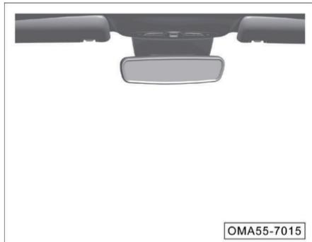
El espejo retrovisor interior antideslumbrante automático monitorea la luz ambiental al frente y detrás del vehículo, a través del sensor de luz, y reduce el brillo o destello del reflejo del espejo, optimizando la visualización del mismo.
