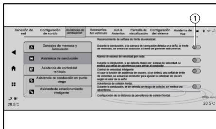
En la interfaz del sistema de infotainment, acceda a “Configuración del sistema → Asistencia de conducción → Control del vehículo”, y presione el interruptor
