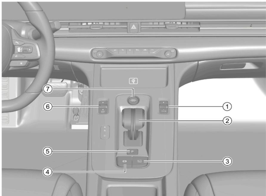
1. Interruptor de apagado / ajuste de volumen.
