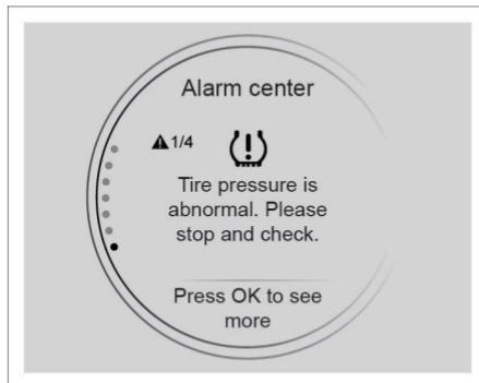
El centro de alarmas se utiliza para almacenar los mensajes de alarma. En esta pantalla se muestra el estado actual del vehículo en forma de texto, sonidos de alerta u otros. El conductor debe estar atento y revisar estos mensajes de alarma.
