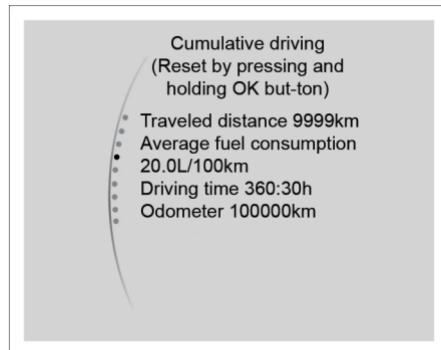
Conducción acumulada: Muestra la información de conducción (Distancia acumulada/Consumo promedio de combustible/Tiempo de conducción) del vehículo desde el último restablecimiento, que puede realizar presionando y manteniendo presionado el botón "OK" del volante. La información del odómetro general se muestra en esta interfaz y no puede ser restablecida.
