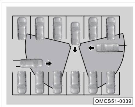
El sistema de alerta de tráfico cruzado trasero (RCTA) detecta en los puntos ciegos a ambos lados de la parte trasera del vehículo a través sensor BSD. Cuando el vehículo está en reversa, y se detecta un vehículo acercándose, el sistema le advertirá al conductor a través de alertas visuales en los retrovisores exteriores, módulo de instrumentos o imagen panorámica (si así está equipado).
