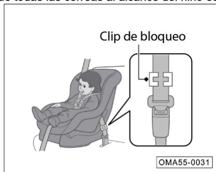
Si el sistema de protección para niños no posee el dispositivo para fijar el cinturón, se debe instalar un clip de bloqueo en el cinturón.
