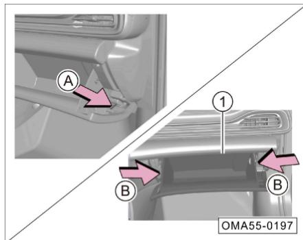
3. Desconecte el retenedor de la guantera tirando en la dirección de la flecha A.
