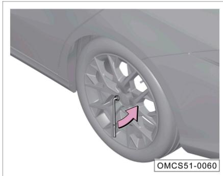
Fije la llave de desmontaje tornillos/tuerzas firmemente y aflojelas girando en el sentido contrario al de las manecillas del reloj.
