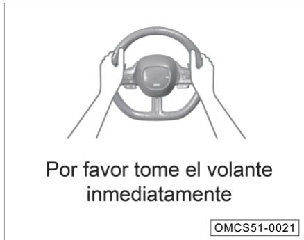
Cuando el LKA detecta que las manos del conductor han sido retiradas del volante por un largo periodo de tiempo, el sistema emitirá una alerta y la pantalla del módulo de instrumentos mostrará el mensaje correspondiente acompañado de una alerta sonora.
