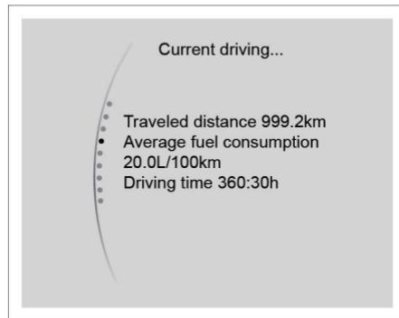
Conducción actual: Muestra la información de conducción (Distancia de viaje/Consumo promedio de combustible/Tiempo de conducción) del vehículo en un viaje después de colocar el interruptor de ignición en la posición "ON" (Encendido), restableciéndose con cada ciclo de ignición.
