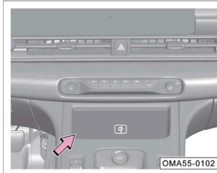
La superficie de carga inalámbrica se encuentra en el compartimiento de almacenamiento al frente del selector de velocidades. Para cargar el dispositivo móvil, por favor alinee la bobina de carga con el logo "Qi" para comenzar con carga.
