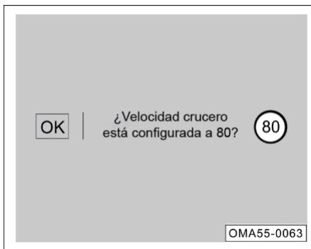
Cuando la ventana emergente muestra el mensaje “OK”, “¿Velocidad crucero esta configurada a X?” y la señalización del límite de velocidad detectado:
