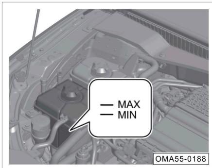
Revise que el nivel de refrigerante en el tanque de expansión de refrigerante del motor está entre la marca superior "MAX" y la marca inferior "MIN".
