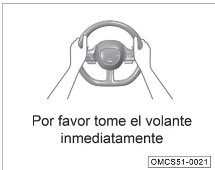
Cuando el ICA detecta que las manos del conductor han sido retiradas del volante por un largo periodo de tiempo, la pantalla del módulo de instrumentos mostrará el mensaje "Por favor tome el volante". Si el conductor no toma el volante, la alerta cambiará al ícono de las manos y la luz indicadora de la asistencia de la dirección destellará, acompañado del mensaje de alerta. Al mismo tiempo, la imagen anterior se mostrará en la pantalla del módulo de instrumentos acompañado de una alerta sonora.
