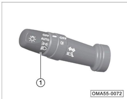
Con el interruptor de ignición en la posición de “Encendido” (ON), gire el interruptor de faros ① para encender o apagar el modo AUTO (encendido automático de faros, si así está equipado), (luces de posición), (faros en luz baja).
