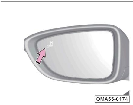
El BSD alerta al conductor a través de la luz indicadora
