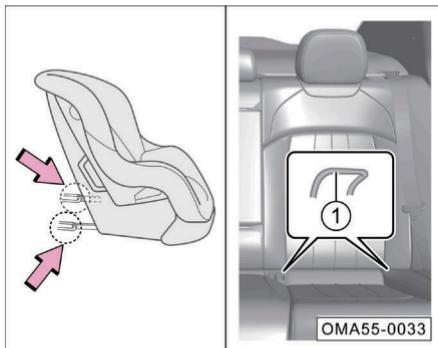
1. Coloque el sistema de protección para niños en el asiento del vehículo, encuentre los puntos de anclaje inferiores ① e inserte el riel de instalación (señalado con las flechas) al punto de fijación inferior ①, hasta que escuche el sonido de "clic".
