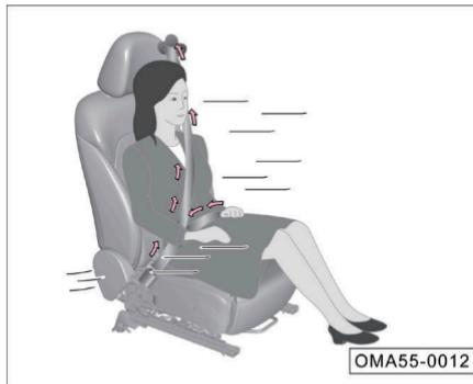
Los limitadores de carga y pretensores de los cinturones de seguridad pueden reducir la fuerza ejercida del cinturón de seguridad sobre el pecho del conductor y ocupantes, mejorando el rendimiento de protección.
