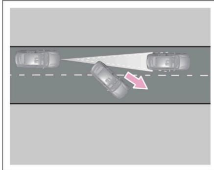
6. Si el vehículo al frente de usted cambia de carril de forma súbita y otro vehículo detenido aparece a poca distancia, el sensor del radar y actuador del freno podrían tener una respuesta aletargada, provocando una respuesta de frenado retardada.
