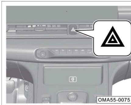
Si presiona el interruptor ▲ con el interruptor de ignición en cualquier posición, la luz indicadora en este interruptor destellará y las luces de advertencia (intermitentes) se encenderán. Presione este interruptor nuevamente para apagar las luces.
