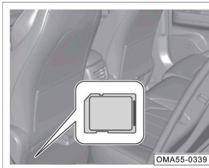
La ECU del sistema de infotainment y puerto de la tarjeta TF/SD se encuentran instalados debajo del asiento del conductor.
