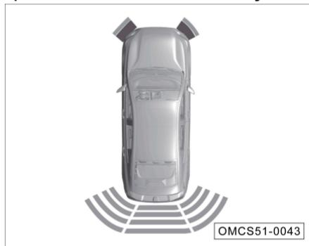
La vista dinámica aparece en la sección superior izquierda de la pantalla, indicando la distancia entre la parte delantera y trasera del vehículo, y el obstáculo. El sector más alejado del vehículo es de color verde, con los sectores medios y más acercados al vehículo de color amarillo y rojo respectivamente. Cuando el obstáculo se acerca más y más al vehículo, los sectores de color se acercarán al ícono del vehículo.
