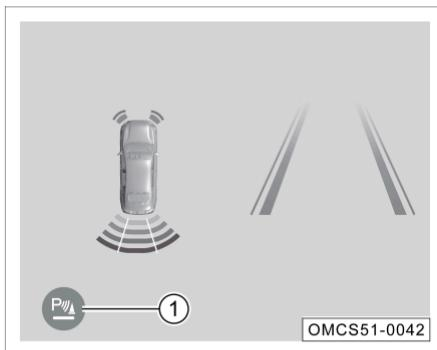
Cuando el sistema RPA está encendido durante la reversa, presione el interruptor 1
