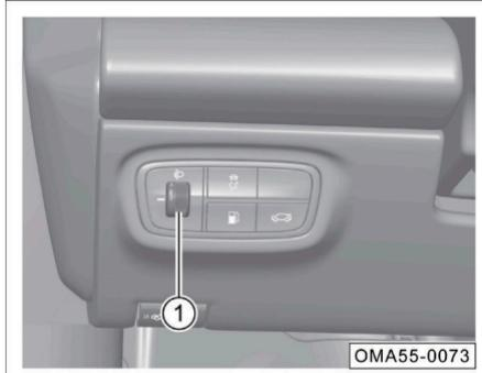
Gire el interruptor ① para ajustar manualmente la altura de los faros (en luz baja) en las posiciones 0, 1, 2 ó 3. El ajuste de altura de los faros se reducirá a medida que el valor numérico aumenta.
