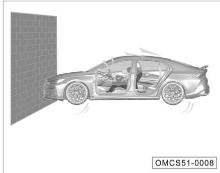
En caso de colisión, el conductor y los pasajeros que no llevan el cinturón de seguridad pueden ser lanzados hacia adelante y sufrir lesiones graves debido a la inercia.
