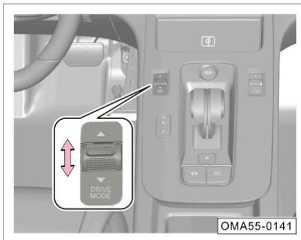
Coloque la ignición en la posición de “Encendido” (ON). Moviendo el interruptor de modos de ignición, puede ciclará entre los modos de la siguiente forma ECO → COMFORT → SPORT → SPORT+ → DIY → ECO.
