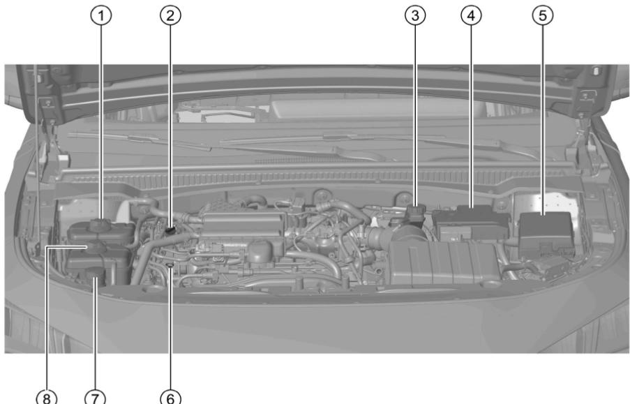
1. Depósito del refrigerante del intercooler.
