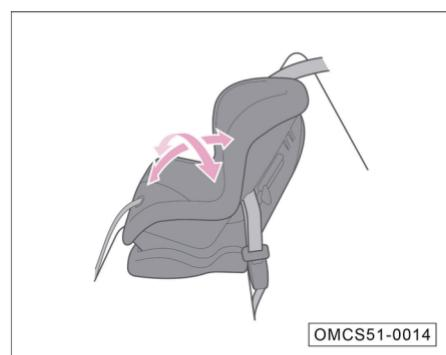
6. Mueva el sistema de seguridad, de atrás hacia delante y de izquierda a derecha para niños para comprobar que se encuentre correctamente ajustado.
