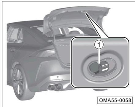
Cuando el vehículo no cuente con batería o la cajuela falle en abrir de forma normal, usted puede intentar la liberación de emergencia al interior del vehículo:
