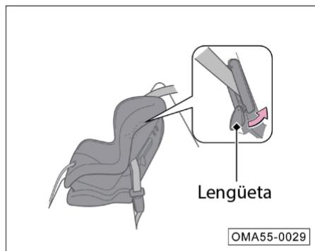
5. Acomode el cinturón de seguridad correctamente y empuje la lengüeta hacia arriba. Asegúrese que el cinturón de seguridad no esté doblado. Mientras mueve la lengüeta hacia arriba, jale la porción superior del cinturón de seguridad para mantener la tensión.
