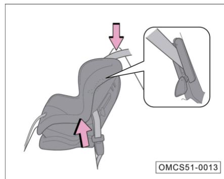
4. Tome la porción superior del cinturón de seguridad cerca de la hebilla de bloqueo y jálelo hacia arriba para tensar la porción inferior del cinturón de seguridad. Mientras tanto, con su propio peso, presione el sistema de protección para niños al asiento.
