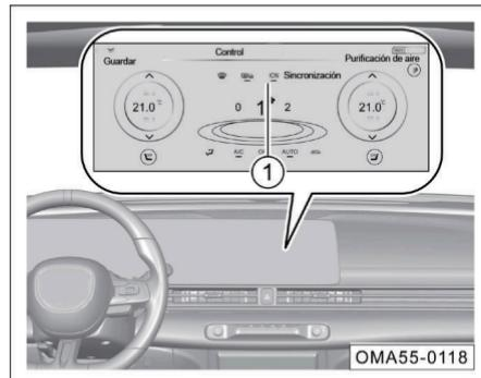
Abra la pantalla de control del sistema de aire acondicionado, presione el interruptor “ION” ① en pantalla, la luz indicadora del interruptor en pantalla se encenderá, y el sistema de aire acondicionado (A/C) encenderá el purificador de plasma. El sistema puede generar iones negativos, que descomponen gases nocivos como formaldehído y bencenos dentro del vehículo, y purifican el aire al interior del vehículo.
