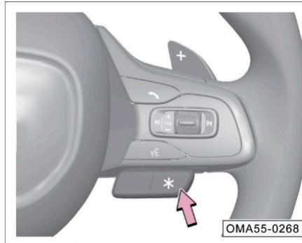
En el costado derecho del volante, existe el interruptor \*. Este interruptor tiene dos estados funcionales, presión corta, y presionar y mantener presionado (presión prolongada). El usuario puede establecer las funciones para el estado de presión prolongada, y presión corta, en la central de control y AVN respectivamente.
