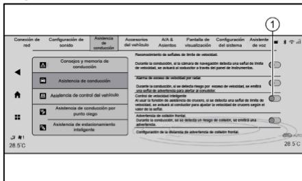
En la interfaz del sistema de infotainment, acceda a “Configuración del sistema → Asistencia de conducción → Control del vehículo”, y presione el interruptor
