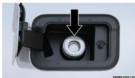
Boca de llenado de combustible
