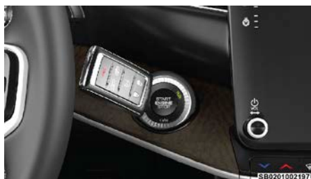
Encendido con batería de transmisor descargada
