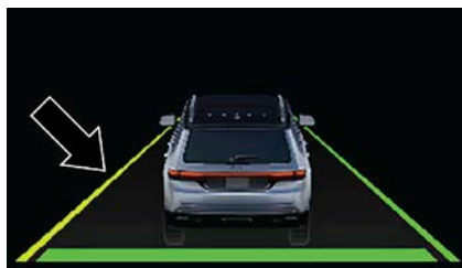
Línea de carril cruzada (líneas amarillas destellando)
