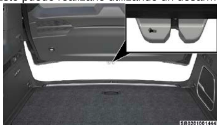
Liberación de servicio de la compuerta levadiza
