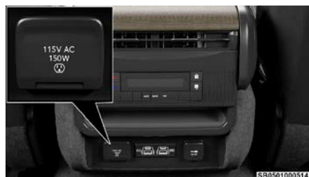
Inversor de corriente
