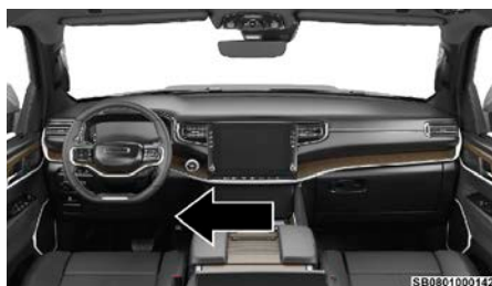
Ubicación del Centro de Distribución de Energía
