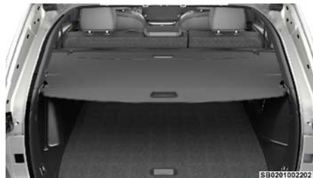
Cubierta del área de carga
