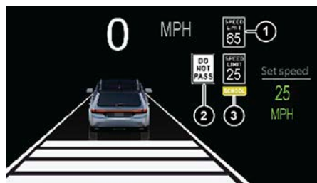
Señales de tráfico reconocidas (Tablero de 12.3 plg mostrado)
