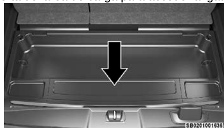
Cubierta de acceso al gato y herramientas
