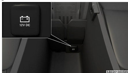
Toma de corriente (si así está equipado)
