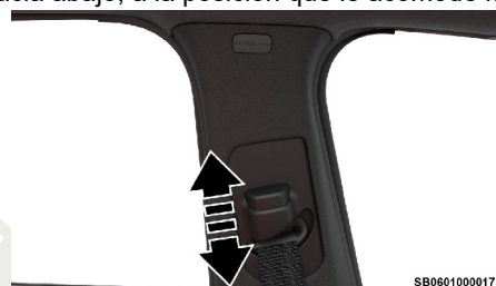
Ajuste superior del cinturón de hombro
