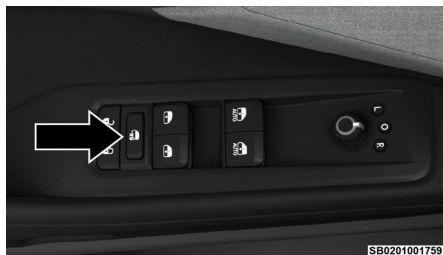
Interruptor de bloqueo de las ventanas
