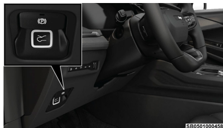
Botón de liberación del compartimiento del motor
