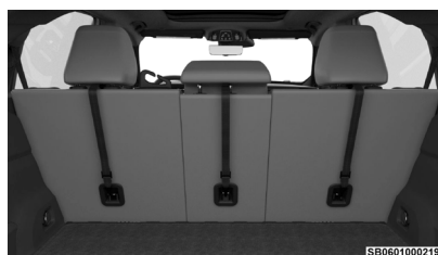
Anclaje de la correa superior
