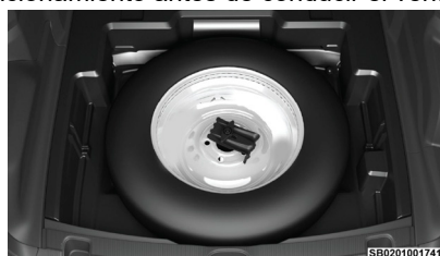
Almacenamiento de la llanta dañada
