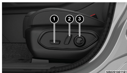
Interruptores del asiento eléctrico
