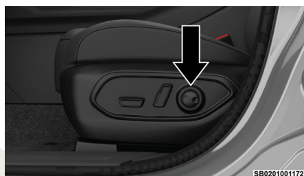
Interruptor del soporte lumbar eléctrico
