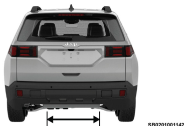
Zona de activación de la compuerta manos libres
