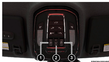
Interruptores del quemacocos
