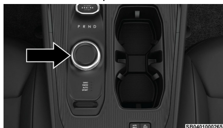
Selector de velocidades de la transmisión
