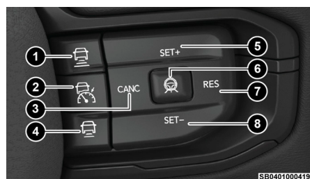
Botones del control crucero adaptativo
