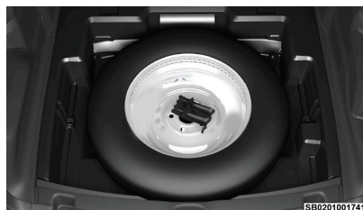
Almacenamiento de la llanta dañada
