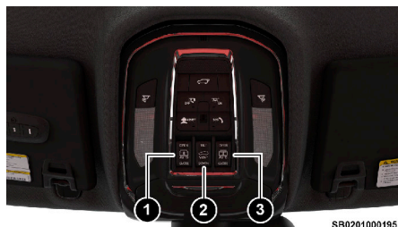
Interruptores del quemacocos
