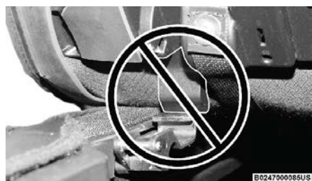
Fijador asentado incorrectamente
