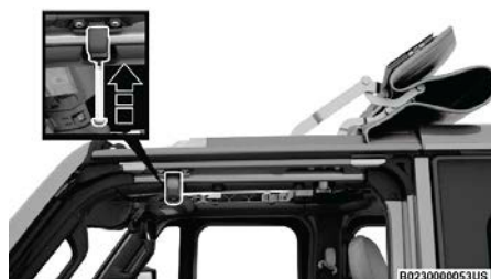
Coloque el tornillo del riel de la puerta delantera
