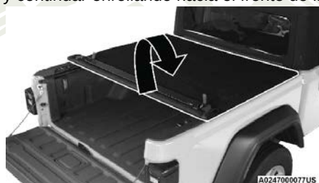
Enrollado de la cubierta hacia el frente
