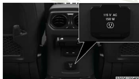
Inversor de corriente
