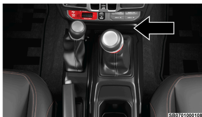
Cubierta de liberación - freno de estacionamiento manual
