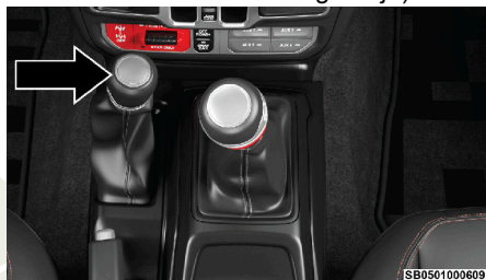
Selector de tracción en las cuatro ruedas
