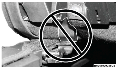
Fijador asentado incorrectamente
