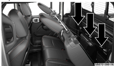
Ubicaciones de anclaje de correa superior
