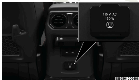
Inversor de corriente
