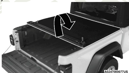
Enrollado de la cubierta hacia el frente
