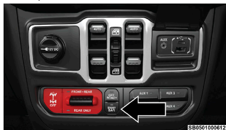
Interruptor de la barra estabilizadora
