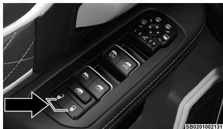
Ubicación del interruptor de bloqueo de la puerta
