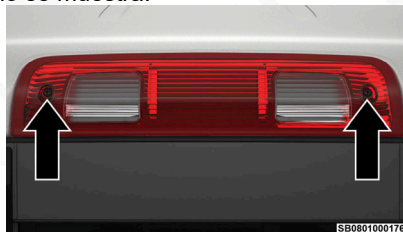
Ubicación de los tornillos de la CHMSL
