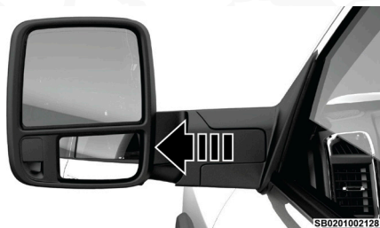
Espejo telescópico de remolque (posición extendida)
