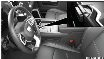
Presione el botón liberador para deslizar la bandeja
