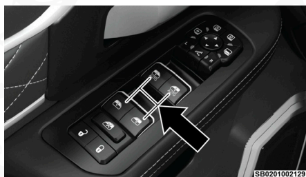
Interruptores de las ventanas eléctricas
