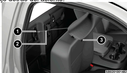
Anclajes en cabina regular
