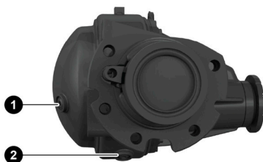
Orificios del eje trasero de modelos 4500/5500
