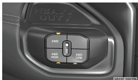
Caja de transferencia de 4 posiciones
