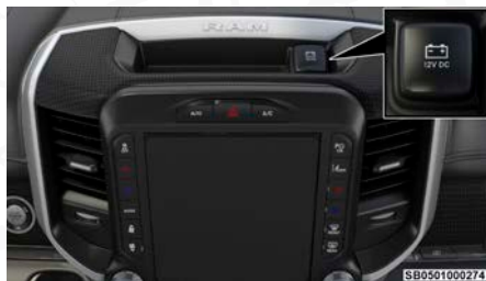
Toma de corriente – Arriba del panel
