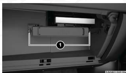
Retiro del filtro de aire
