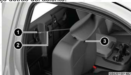
Anclajes en cabina regular
