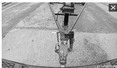
Acoplador del remolque ensamblado correctamente
