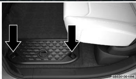
Ganchos del compartimiento de almacenamiento
