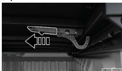
Deslice la palanca de bloqueo hacia adentro
