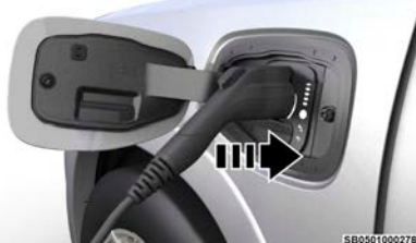
Inserte el conector de carga dentro del puerto de carga del vehículo
