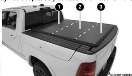
Posición 2 (seguros delanteros y traseros acoplados)
