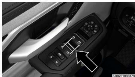
Interruptores de las ventanas eléctricas
