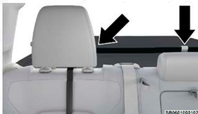
Correa de sujeción a través del aro de sujeción lateral conectado al aro de sujeción central
