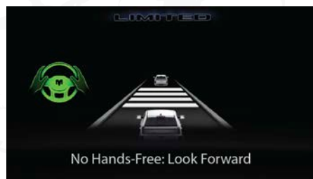
Asistente de conducción activa activado (Volante en verde)
