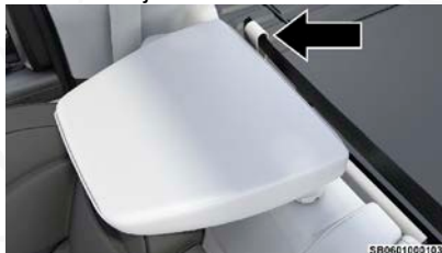
Correa de anclaje a través del aro de sujeción en asiento
