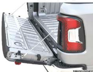
Compuerta únicamente soportada por cables
