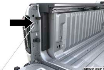
Anclaje del cable de soporte
