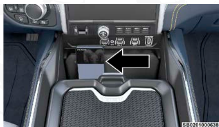
Llave digital en la superficie de carga inalámbrica (lado del NFC)
