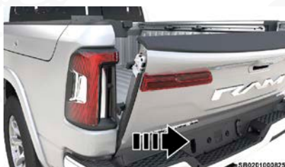
Deslice la compuerta trasera hacia la derecha
