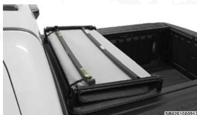
Cubierta completamente doblada
