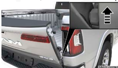
Levante el lado derecho fuera del pivote
