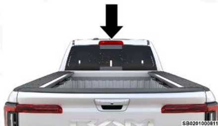
Luces del área de carga/batea
