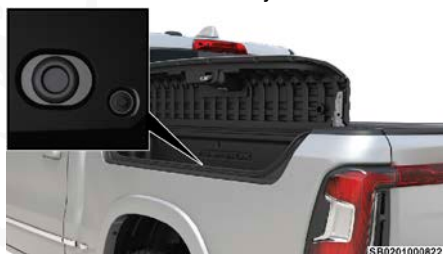
Retiro de los sellos de drenaje del RamBox
