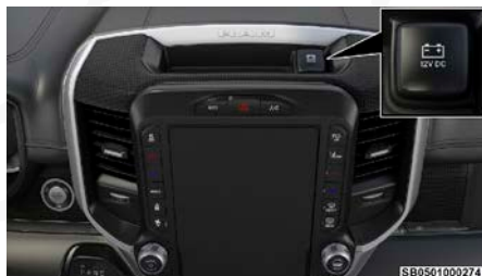
Toma de corriente – Parte superior del panel
