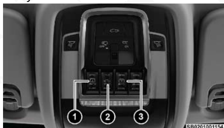
Interruptores eléctricos del toldo solar
