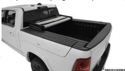
Posición uno (ganchos delanteros acoplados y correas aseguradas)
