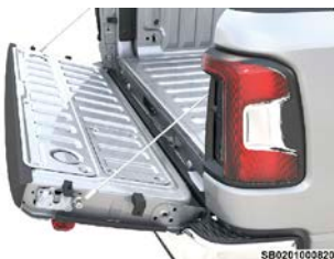
Compuerta trasera sostenida solo por los cables de soporte
