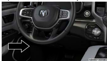
Cubierta de fusibles
