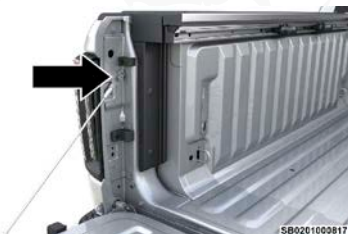
Anclaje del cable de soporte
