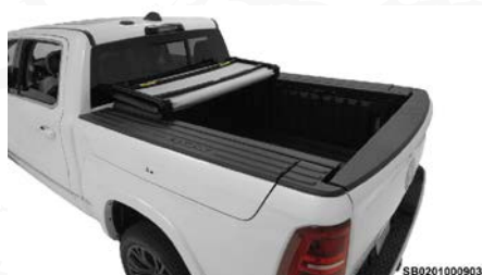
Posición 1 (seguros acoplados y correas de almacenamiento aseguradas)
