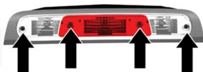
Ubicación de tornillos de montaje de la CHMSL
