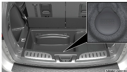
Ubicación de la conexión del malacate
