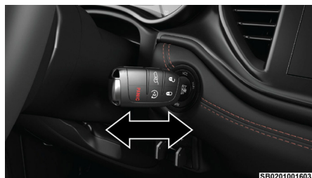
Encendido con batería de transmisor descargada
