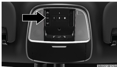
Interruptor de toldo solar eléctrico
