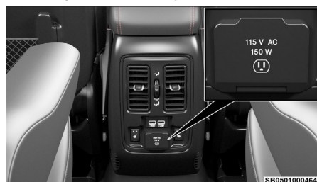
Inversor de corriente
