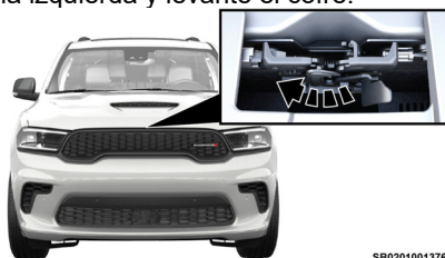
Localización de anclaje de seguridad
