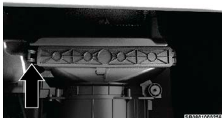
Cubierta del filtro del A/C
