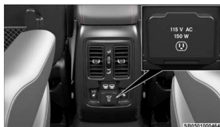
Inversor de corriente
