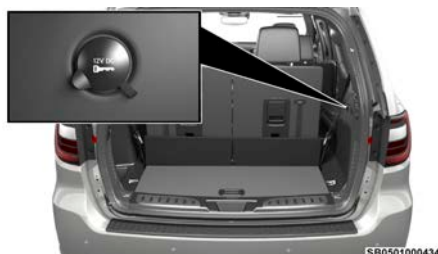
Toma de corriente del área de carga
