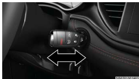
Encendido con batería de transmisor descargada
