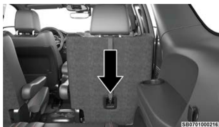
Instalación de los anclajes de correa superior (6 pasajeros) (Silla tipo capitán)
