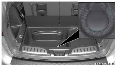
Ubicación de la conexión del malacate
