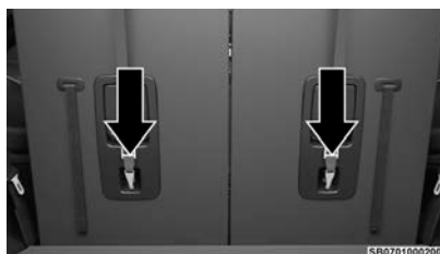
Montaje de la correa superior (tercera fila)
