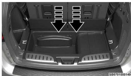
Desmontaje del panel alfombrado para acceder al anclaje de correa (6 pasajeros) (3a. fila de asientos tipo banca)
