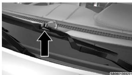
Pluma del limpiador con la pestaña en posición de bloqueo
