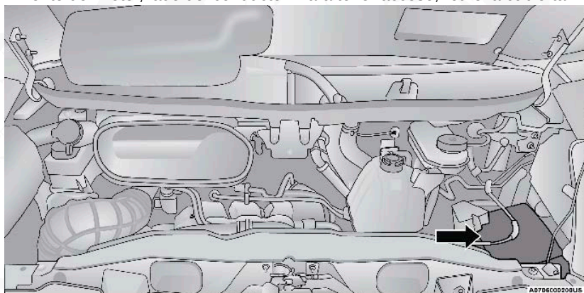
Centro de distribución de energía frontal
