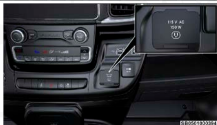
Ubicación del Inversor de Corriente
