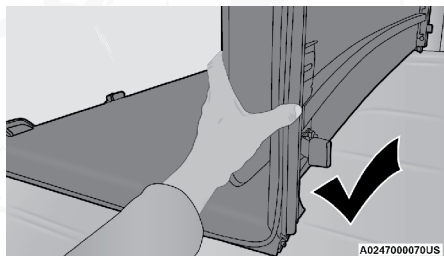
Doblado correcto - Mantenga paneles juntos
