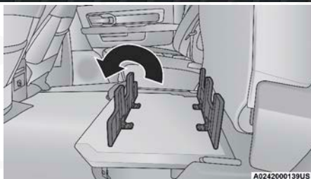
Piso de carga en posición abierta
