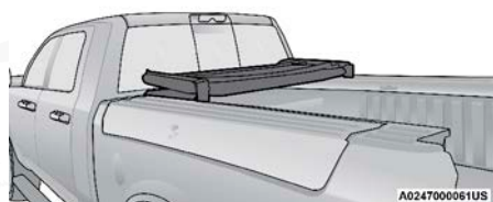
Posición de triple pliegue
