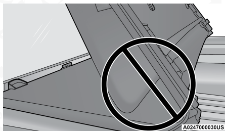
Doblado incorrecto - Causará daño
