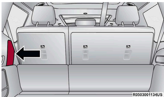
Ubicación del centro de distribución de energía trasero
