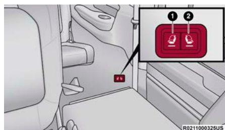
Interruptores de plegado eléctrico en el pilar C (lado izquierdo)
