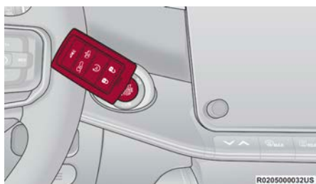
Encendido con batería de transmisor descargada
