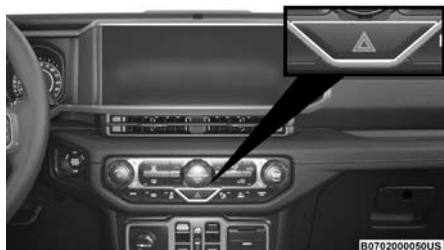
Interruptor de las luces de emergencia
