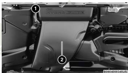
Primera cámara de separación de agua
