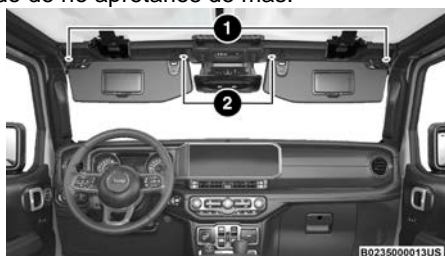
Ubicación de los tornillos Torx al interior
