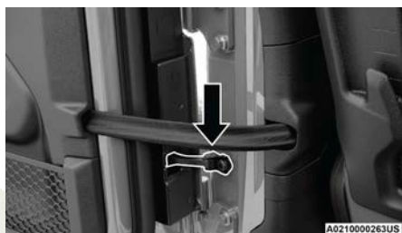
Retenedor de la puerta (enganchado)
