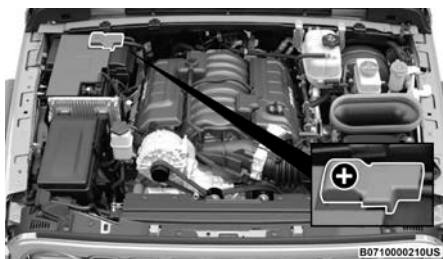
Poste positivo (+) de la batería — Motor 6.4L
