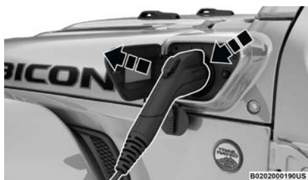
Extracción del conector de carga de la entrada de carga del vehículo
