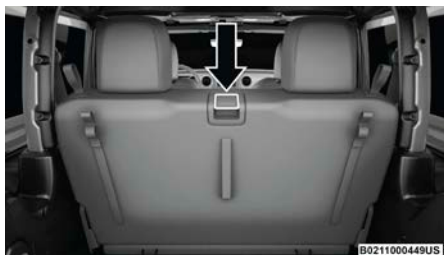
Palanca de liberación del asiento trasero
