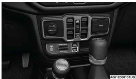
Interruptor de la barra estabilizadora
