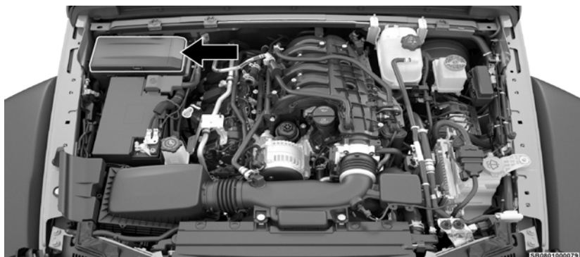
Ubicación del centro de distribución de potencia
