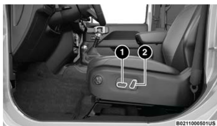
Interruptores eléctricos del asiento
