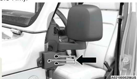
Ubicación de los tornillos del espejo
