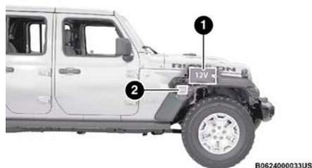
Ubicación de las baterías
