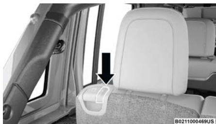
Palanca de liberación de la cabecera trasera
