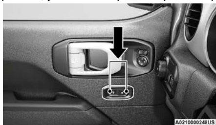
Interruptor del seguro eléctrico de la puerta
