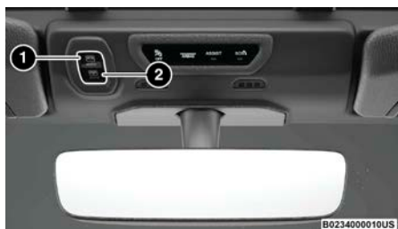
Interruptor de control del toldo eléctrico deslizable
