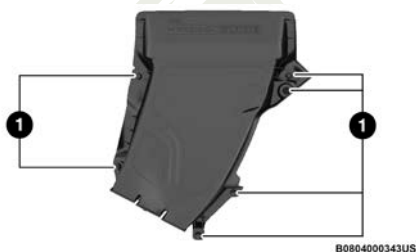
Cámara de separación de agua
