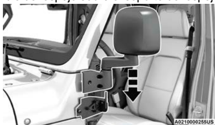
Conjunto de espejo inferior sobre soporte
