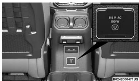
Inversor de corriente
