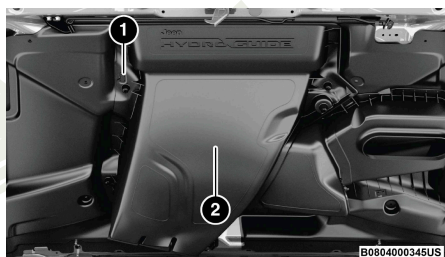
Primera cámara de separación de agua
