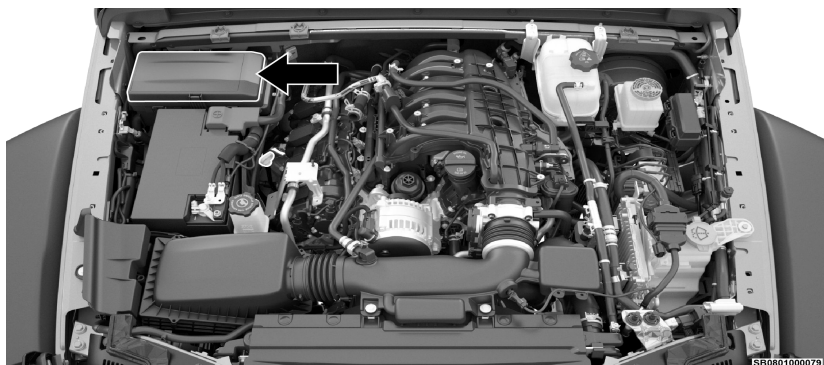
Ubicación del centro de distribución de potencia
