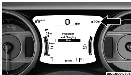
Pantalla de batería de alto voltaje
