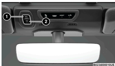
Interruptor de control del toldo eléctrico deslizable
