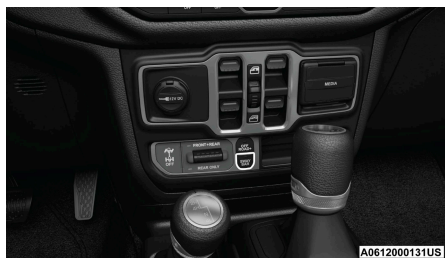
Interruptor de la barra estabilizadora
