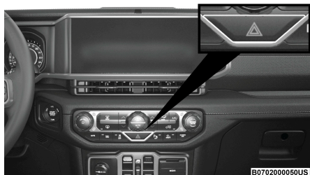
Interruptor de las luces de emergencia
