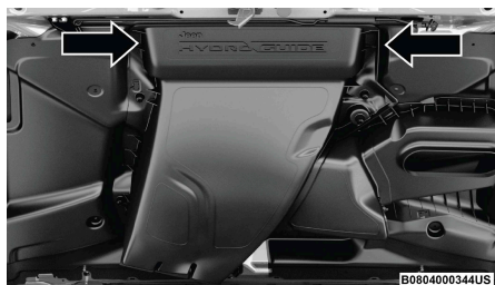
Desinstalación de la cámara de separación de agua
