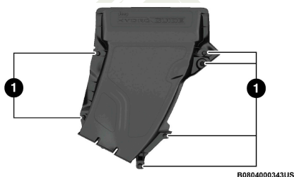
Cámara de separación de agua
