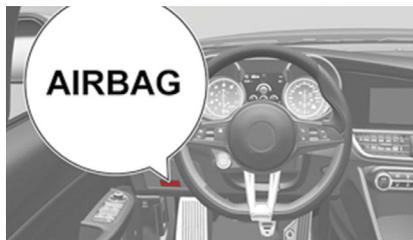
**Bolsa de aire para rodillas del conductor**
