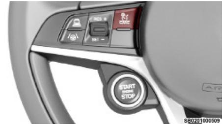
**Botón de apagado/encendido del control electrónico de velocidad de crucero**
