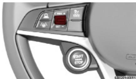
Interruptor SET del control de velocidad electrónico
