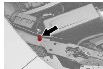
Ubicación del poste remoto negativo (-)
