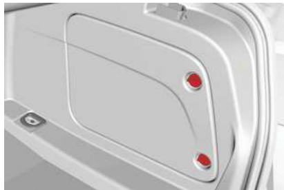
Panel de acceso a la Batería
