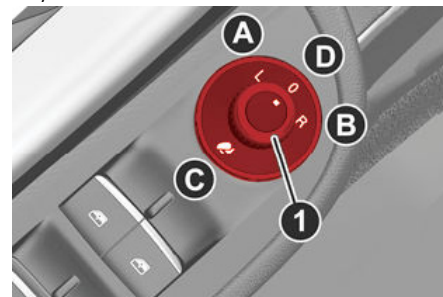
Control eléctrico del espejo
