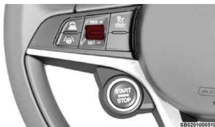
Interruptor SET del control de velocidad electrónico
