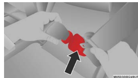
Separando la mini hebilla con lengüeta
