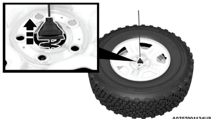
Reinstalando el retenedor
