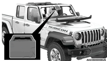
Cubierta protectora instalada
