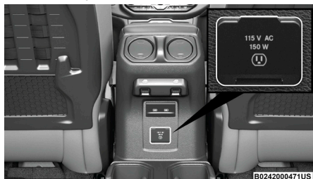
Inversor de corriente
