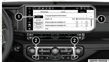
Botones en pantalla y tablero del sistema Uconnect® 5 NAV con pantalla de 12.3”
