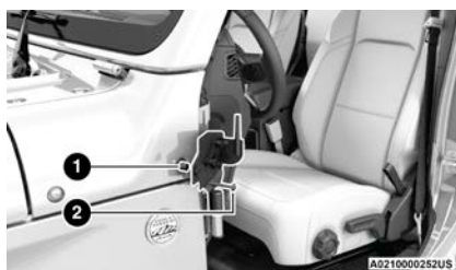
Colocación del soporte del espejo en el vehículo
