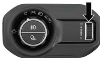
Control de atenuación
