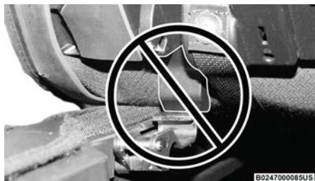
Fijador asentado incorrectamente
