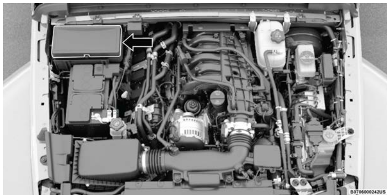
Centro de distribución de Energía
