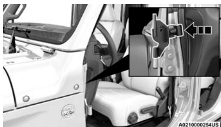
Empuje el soporte sobre el pilar A
