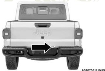
Orificio de acceso al mecanismo del malacate
