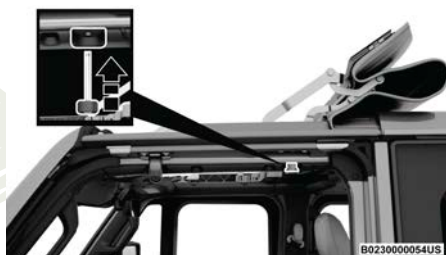
Coloque el tornillo del riel de la puerta trasera
