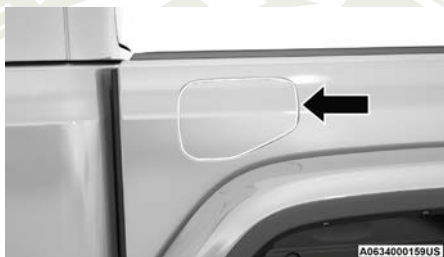
Compuerta del tapón de combustible
