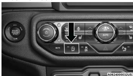
Interruptor de apagado (OFF) del sistema
