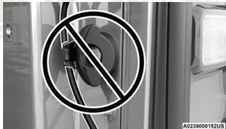
Cable de la compuerta trasera asentado incorrectamente
