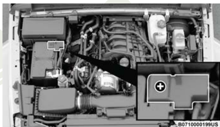
Poste positivo de la batería-Motor a gasolina
