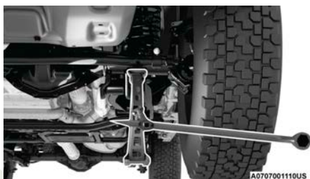
Colocación del gato en la parte delantera
