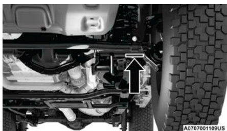
Punto de levantamiento en la parte delantera
