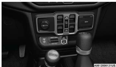
Interruptor de la barra estabilizadora
