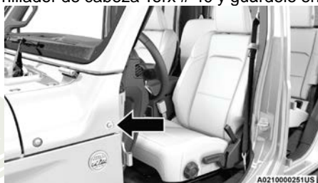
Ubicación del perno de la cubierta
