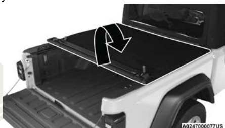
Enrollado de la cubierta hacia el frente
