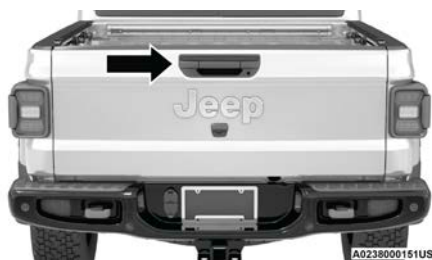
Manija de liberación de la compuerta trasera
