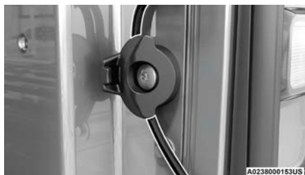
Cable de la compuerta trasera correctamente asentado
