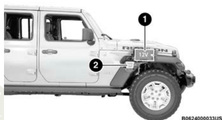
Ubicación de las baterías
