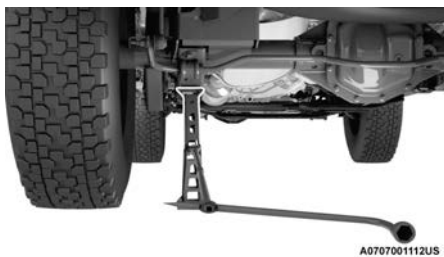
Colocación del gato en la parte trasera
