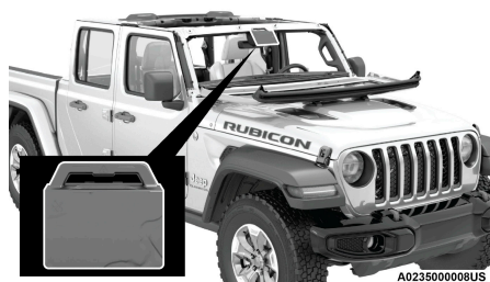
Cubierta protectora instalada
