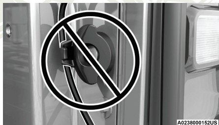
Cable de la compuerta trasera asentado incorrectamente
