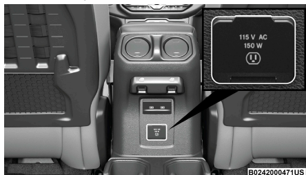
Inversor de corriente
