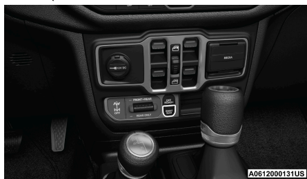
Interruptor de la barra estabilizadora
