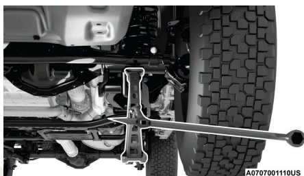
Colocación del gato en la parte delantera
