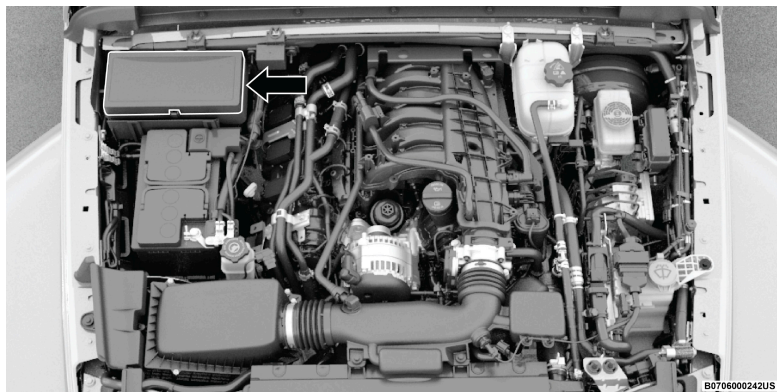
Centro de distribución de Energía
