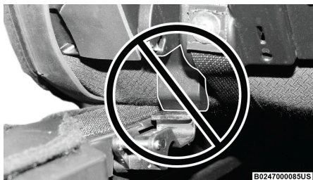
Fijador asentado incorrectamente
