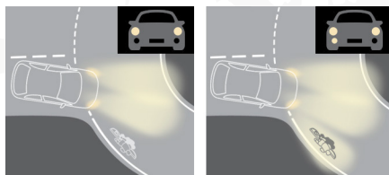
Sin iluminación de intersección / Con iluminación de intersección
