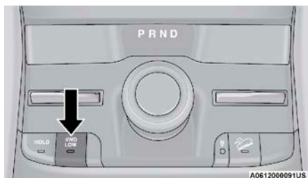
Interruptor de la caja de transferencia
