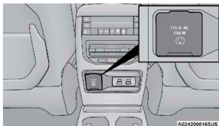
Inversor de corriente
