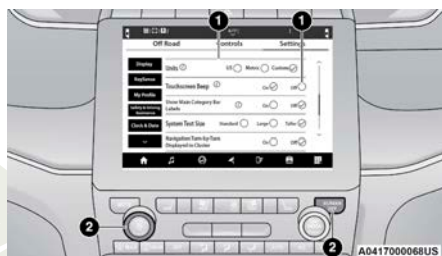
Botones en pantalla y tablero del sistema Uconnect® 5/5 NAV con pantalla de 10.1"
