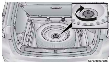
Reinstalación del sujetador de la llanta
