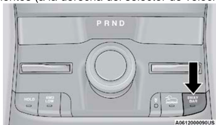
Interruptor de la barra estabilizadora
