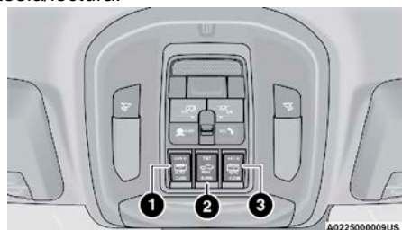
Interruptores de toldo solar y cortinilla
