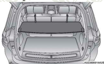
Cubierta del área de carga
