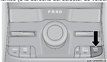
Interruptor de la barra estabilizadora
