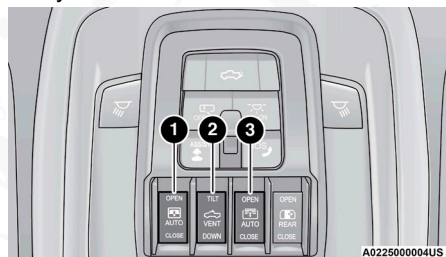
Interruptores eléctricos del toldo solar
