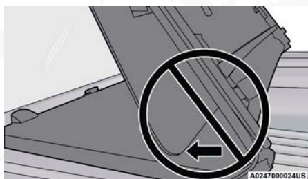
Doblado incorrecto - Puede dañarse
