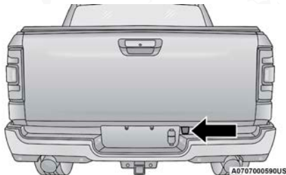
Ubicación de la cubierta de acceso al orificio
