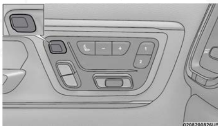
Interruptor de cabeceras eléctricas de cuatro vías
