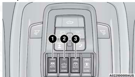
Interruptores eléctricos del toldo solar
