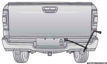
Introduciendo la extensión del tubo al orificio de acceso
