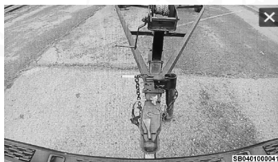
Acoplador del remolque ensamblado correctamente
