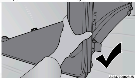
Doblado correcto - Mantenga los paneles juntos
