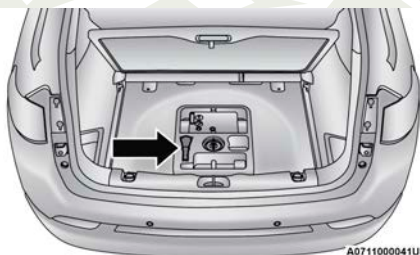
Ubicación del embudo de llenado de emergencia
