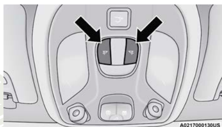
Interruptores de luces de consola superior
