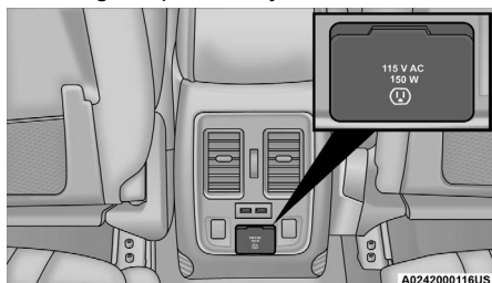
Inversor de corriente
