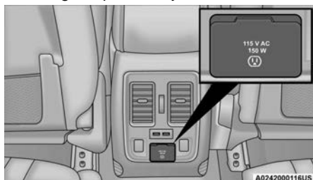
Inversor de corriente
