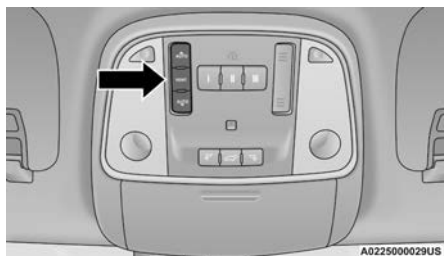
Interruptor de toldo solar eléctrico
