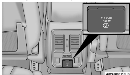
Inversor de corriente
