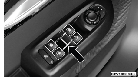
Interruptores de las ventanas
