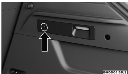
Ubicación del liberador de la compuerta.
