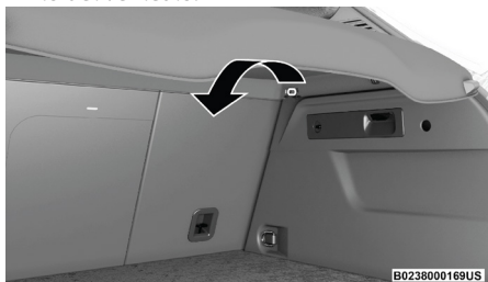
Retiro del poste de la cubierta
