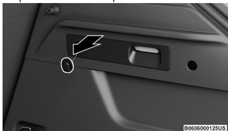
Liberación de emergencia de la compuerta
