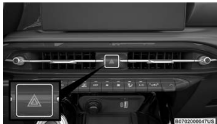
Interruptor de las luces de emergencia
