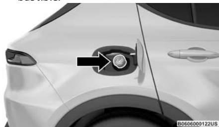
Tubo de llenado de combustible
