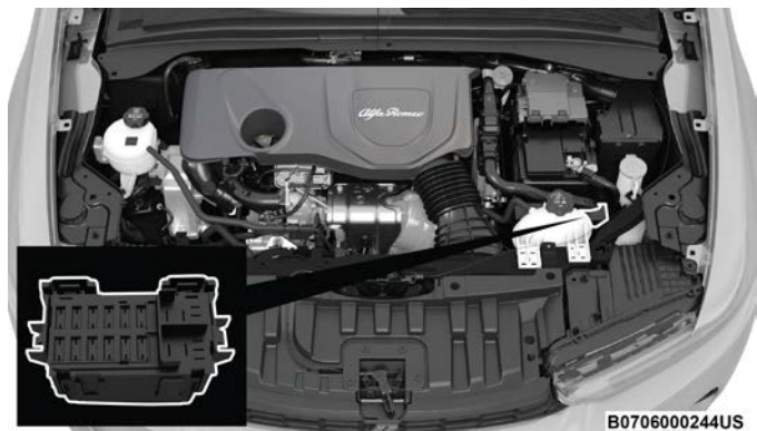
Ubicación de la caja de fusibles suplementaria
