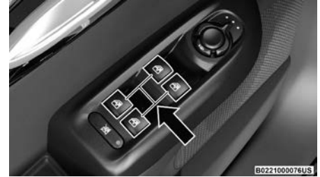
Interruptores de las ventanas
