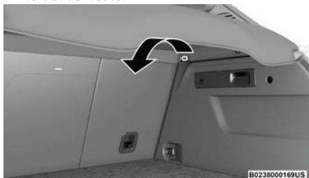
Retiro del poste de la cubierta
