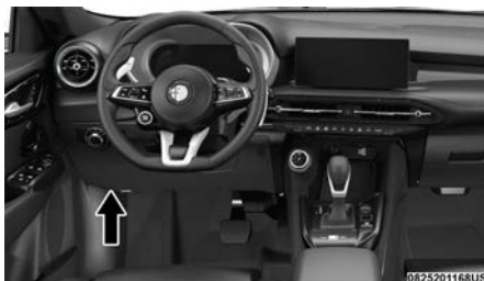
Ubicación de los fusibles interiores
