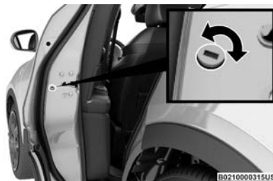
Bloqueo de emergencia
