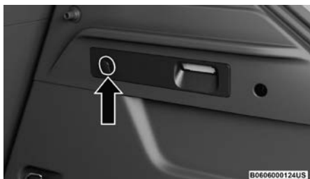
Ubicación del liberador de la compuerta.
