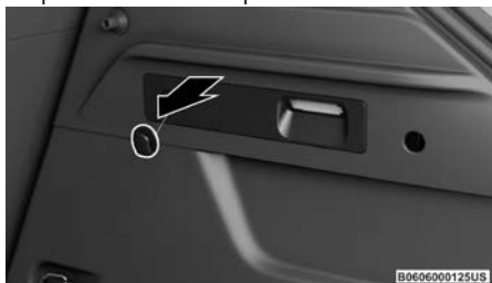
Liberación de emergencia de la compuerta
