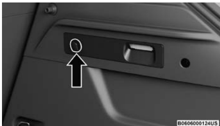
Ubicación del liberador de la compuerta.
