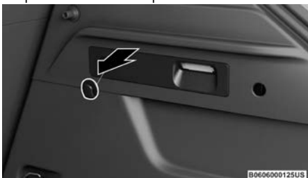
Liberación de emergencia de la compuerta
