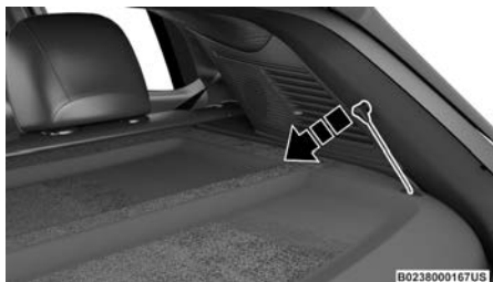
Desconexión de los postes de la cubierta
