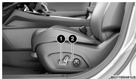
Interruptor del asiento eléctrico
