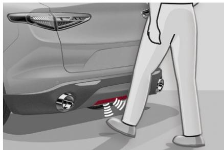
**Zona de activación de la compuerta trasera**
