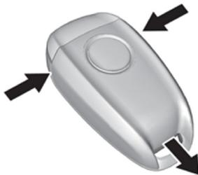
**Retiro de la cubierta del transmisor**
