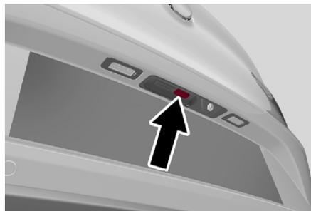
**Botón externo de liberación de compuerta trasera (modelos con entrada pasiva)**
