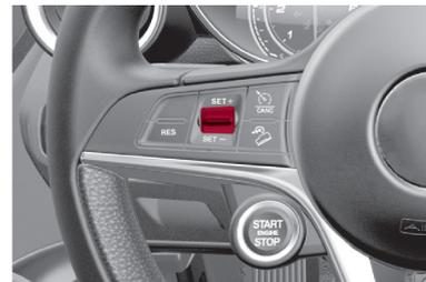
**Interruptor SET del control electrónico de velocidad**
