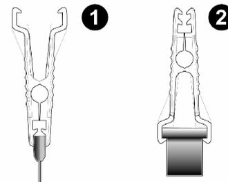
Pinza de extracción de fusibles
