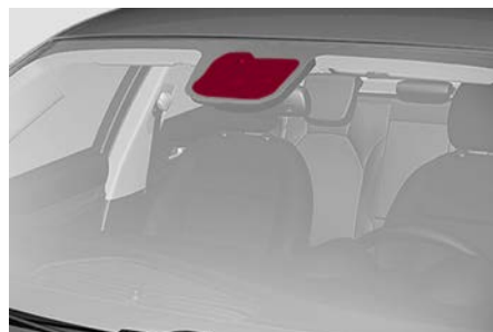
Ubicación de la cámara del parabrisas
