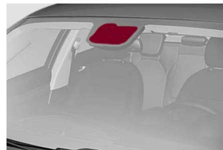
Ubicación de la cámara del parabrisas
