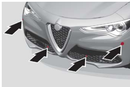
Ubicación de los sensores delanteros
