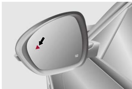
Ubicación de luz indicadora del BSM
