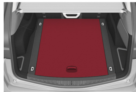
Piso del área de carga
