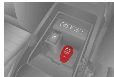
Ubicación para la colocación del transmisor
