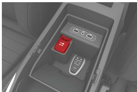
Inversor de corriente
