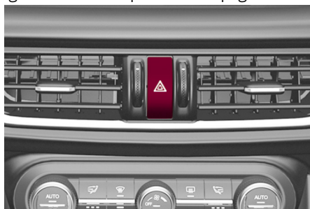
Interruptor de las luces de emergencia
