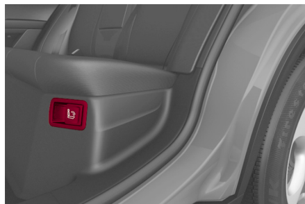
Palanca de liberación del respaldo debajo del asiento trasero
