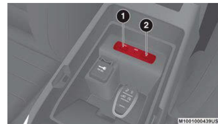
Puerto USB del tablero de instrumentos
