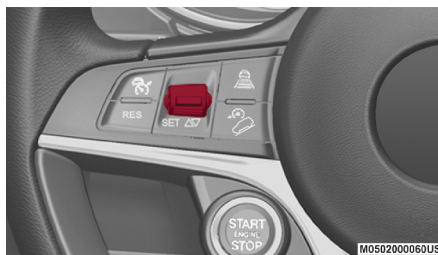
Interruptor SET para velocidad del HDC
