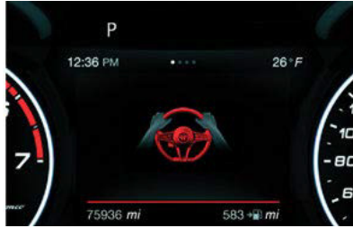
Pantalla de presencia de manos en el volante no detectada (hasta por 6 segundos)
